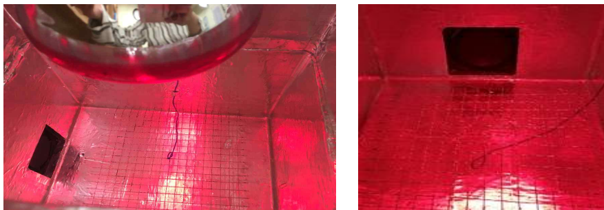
그림 3-21. 본 연구에 사용한 적외선 조사 장치. 벽면의 팬을 통한 내부 수증기 제거.
