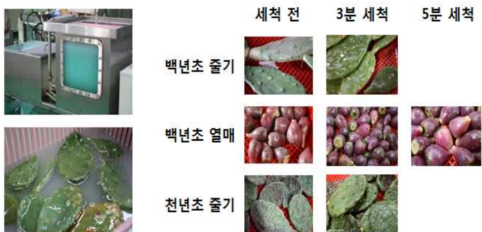
그림 2-61. 마이크로 버블 세척기와 3분, 5분 세척에 따른 결과
