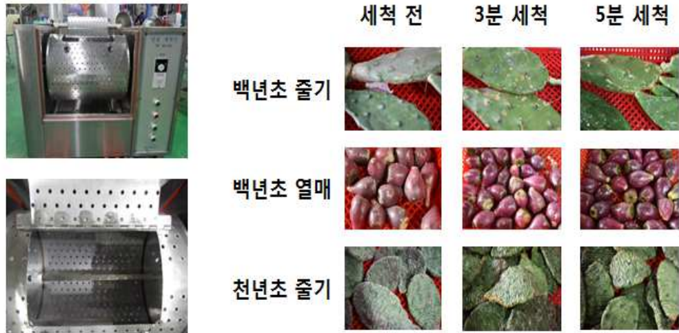
그림 2-59. 회전 원통형 고압 살수 세척기와 3분, 5분 세척에 따른 결과
