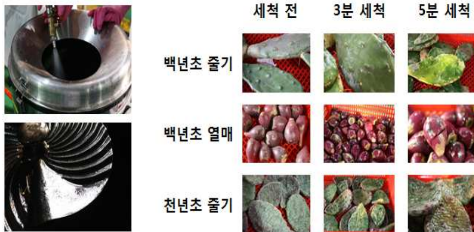
그림 2-62. 구근박피기와 3분, 5분 세척에 따른 결과
