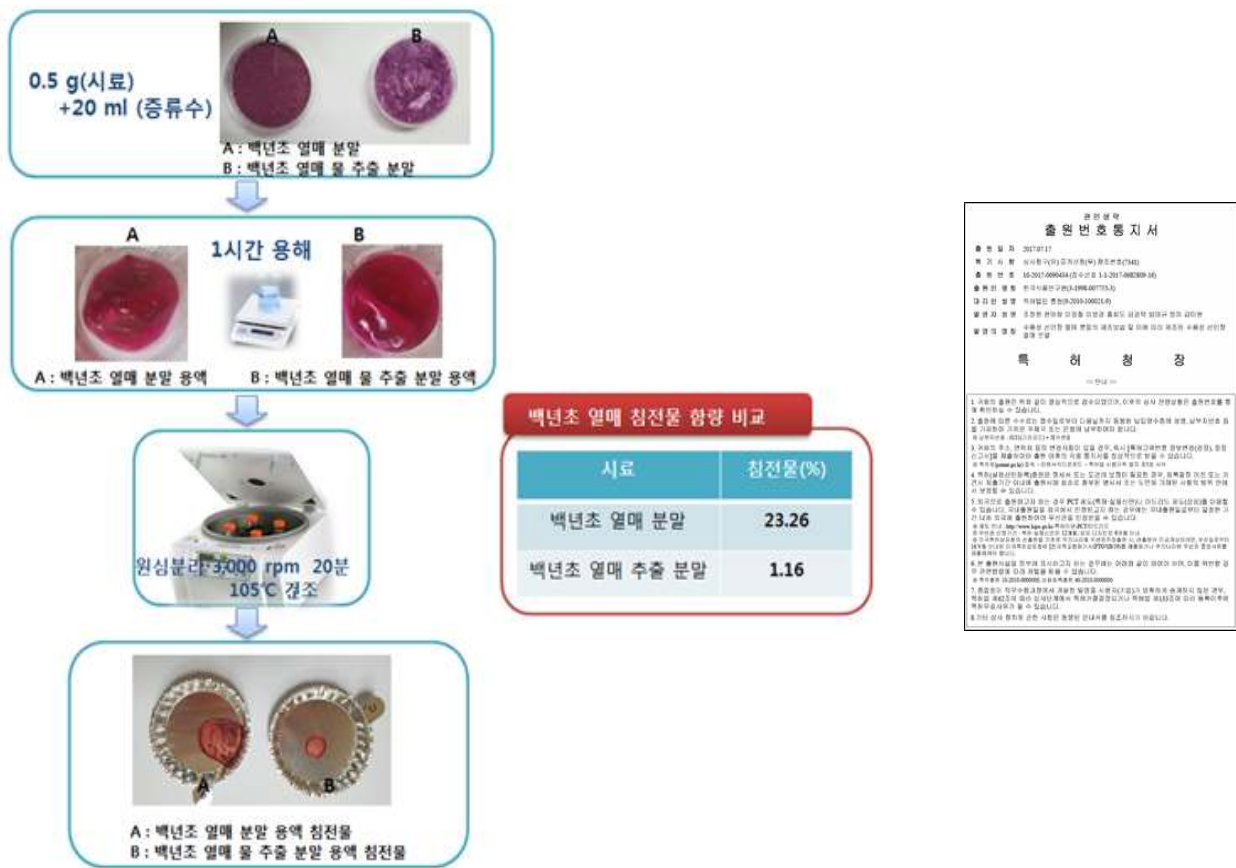
그림 2-49. 색도 안정 및 가용성이 증진된 백년초 열매 분말의 제조공정
