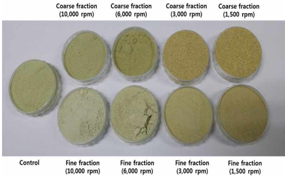
그림 2-68. 공기분급 시스템으로 회수된 각 조건별 분획물의 형태
