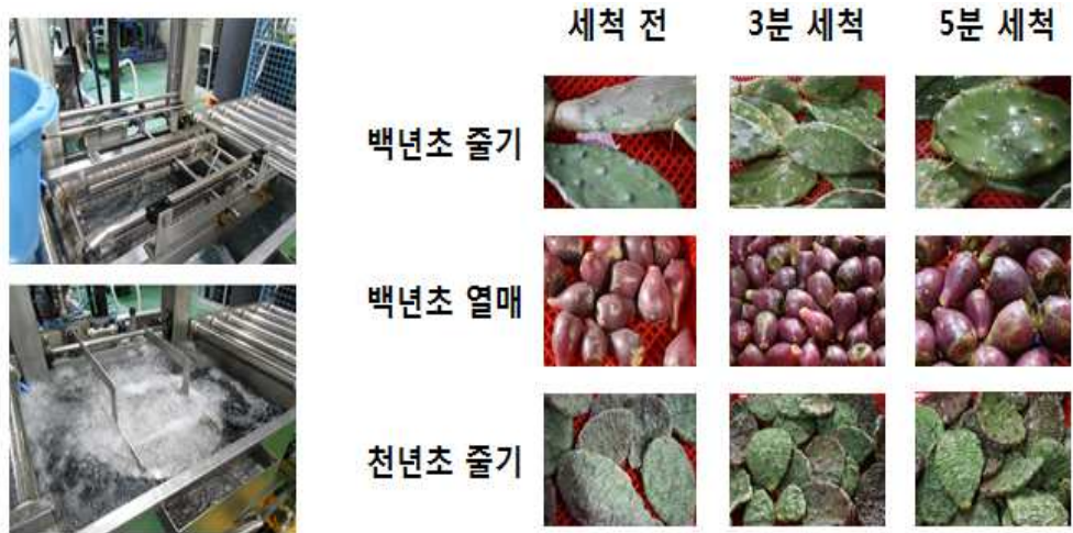
그림 2-60. 침지식 plot bucket 진동 세척기와 3분, 5분 세척에 따른 결과
