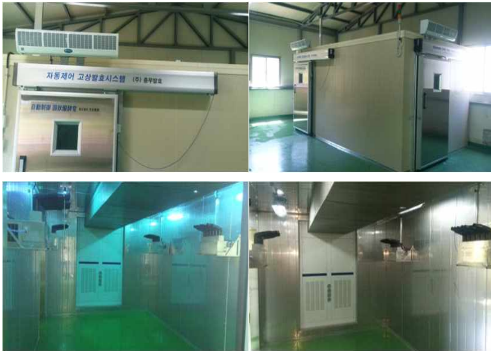
Figure 7-4. 곰팡이 종균용 고상 발효 배양시스템의 설계.
