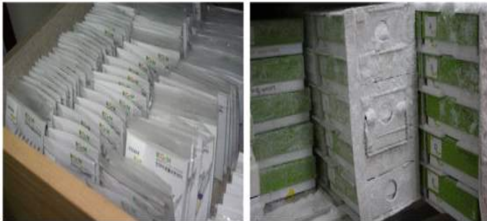
Figure 5-17. 식품 산업용 균주의 안전 보존(좌: 동결건조 앰플, 우: 초저온냉동고 동결 보존).
