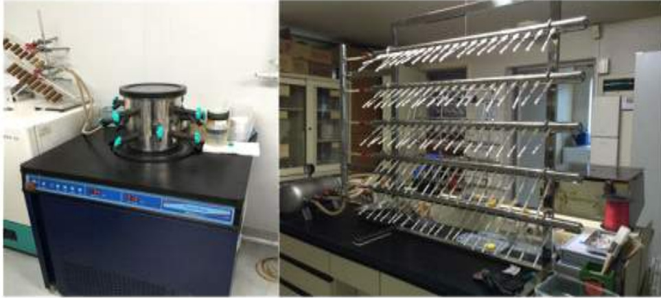
Figure 5-16. 식품 산업용 미생물 자원 동결건조 과정(좌: 동결건조기, 우: 앰플 성형틀).
