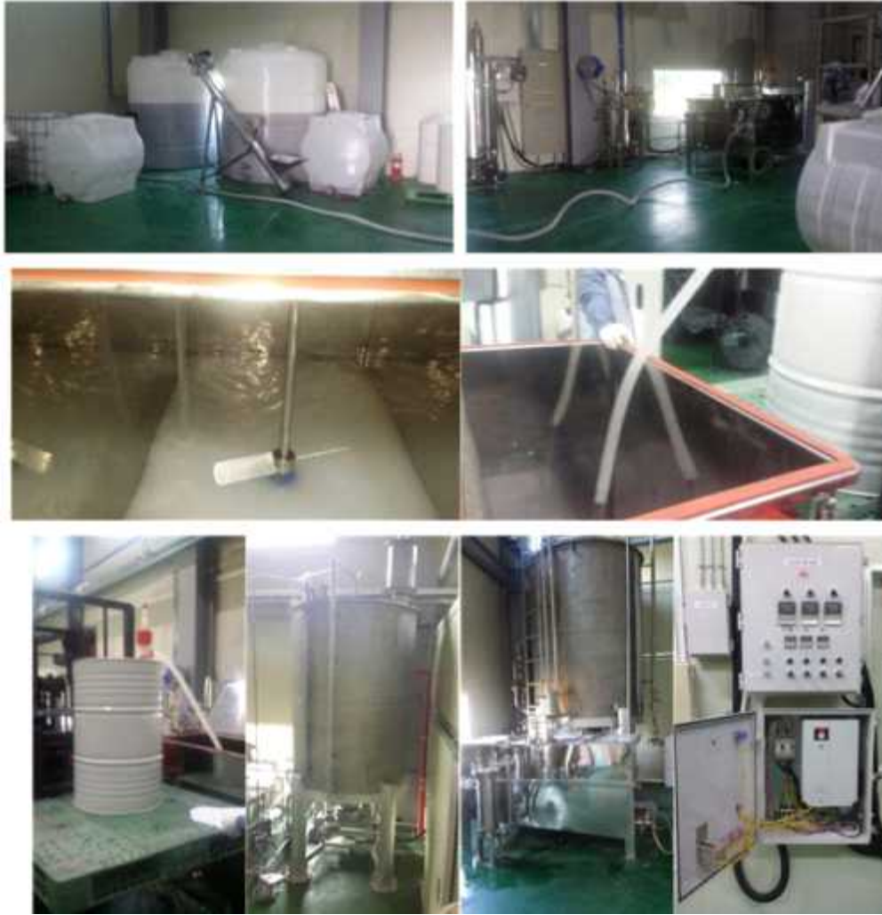
그림 32. 5 ton Acetator 초산발효 pilot test
