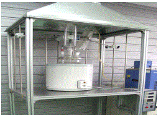
그림. 바인더(Poly acrylate) 합성장치 및 합성공정
