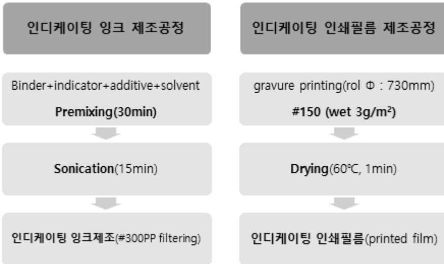
그림. 2-5-1 인디케이팅 잉크 및 인쇄필름 제조공정 모식도
