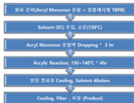
그림. 바인더(Poly acrylate) 합성장치 및 합성공정
