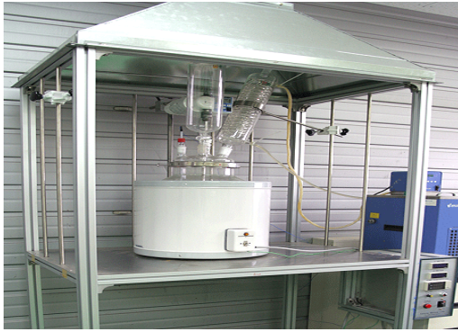
그림. 바인더(Poly acrylate) 합성장치 및 합성공정
