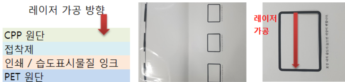
그림 4. 습도 표시물질 레이저 가공 방법
