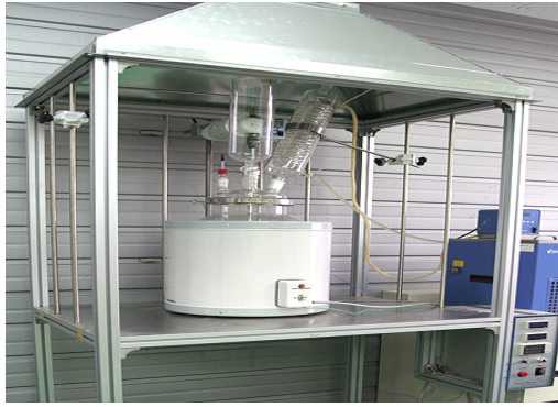
그림 2441. 바인더(Poly acrylate) 합성장치 및 합성공정
