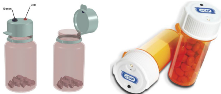
그림 29. Button과 LED 등이 장착된 e-Cap
