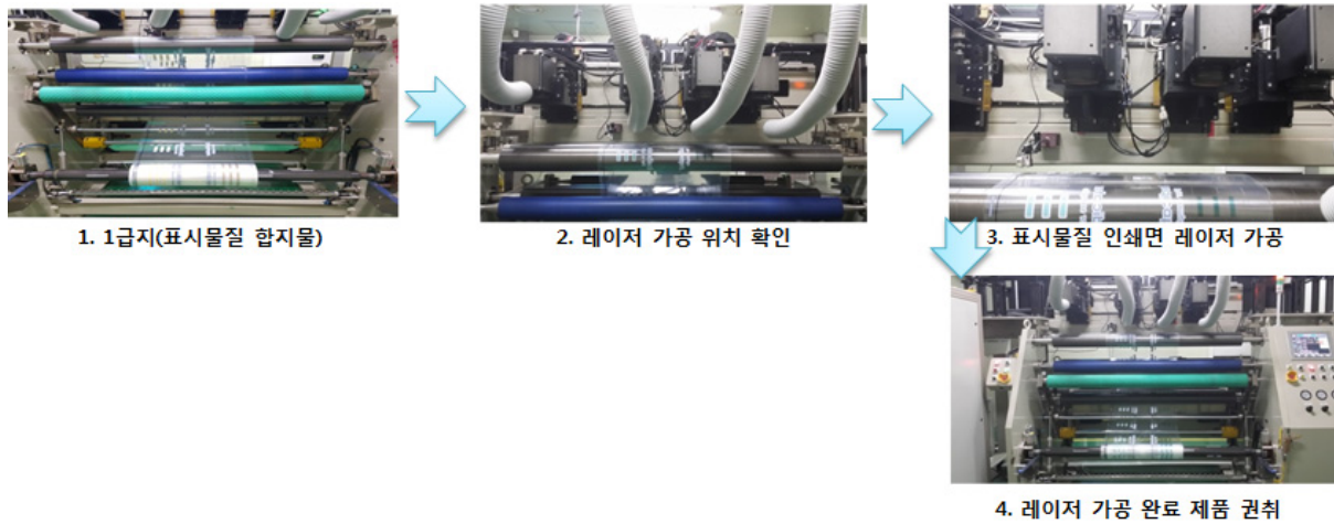
그림 3. 습도 표시물질 레이저 가공 공정 흐름.
