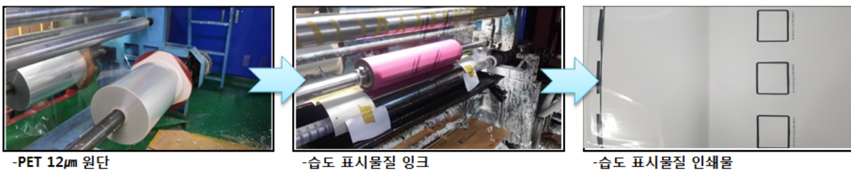
그림 1. 습도 표시물질 인쇄 생산 과정 및 인쇄물 확인.
