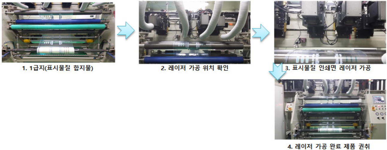
그림. 표시물질 레이저 가공 공정 흐름
