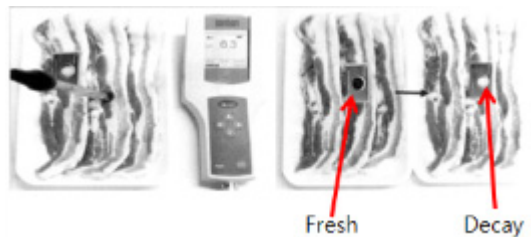
그림. pH민감성 고분자 합성을 통한 신선도 인디케이터
