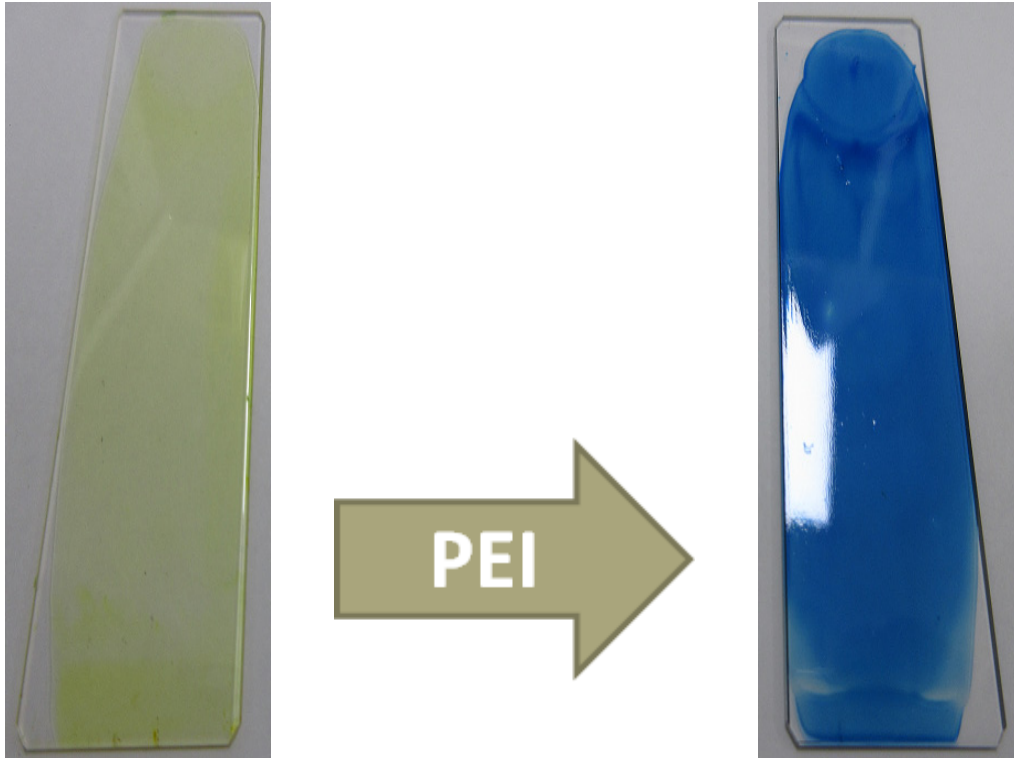
그림. PEI 부가 전과 후의 \text{BTB}^-/\text{TBA}^+ PS 수지
