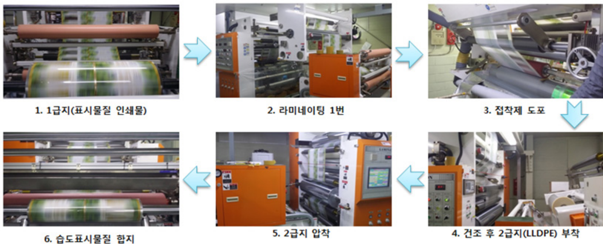
그림 2. 습도 표시물질 Dry Laminating(합지) 공정 흐름
