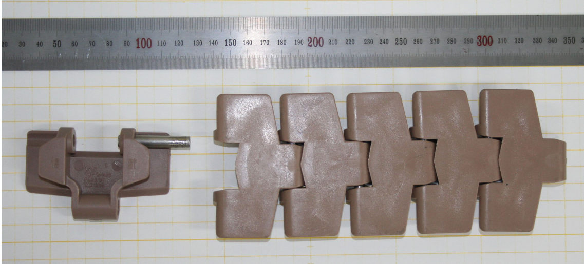
그림 144 컨베이어 벨트 기준품 및 조립품 시편 (재질: PP)
