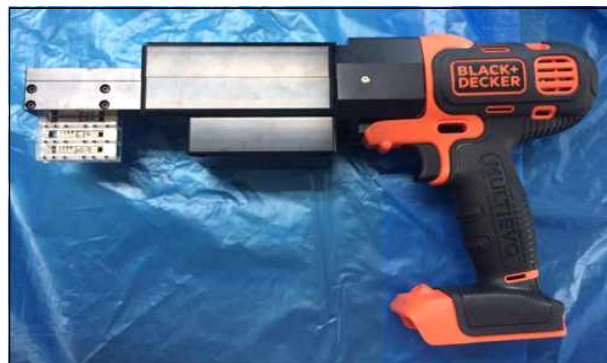
그림 3-42. 시료채취기 3구 카트리지 장착 측면.
