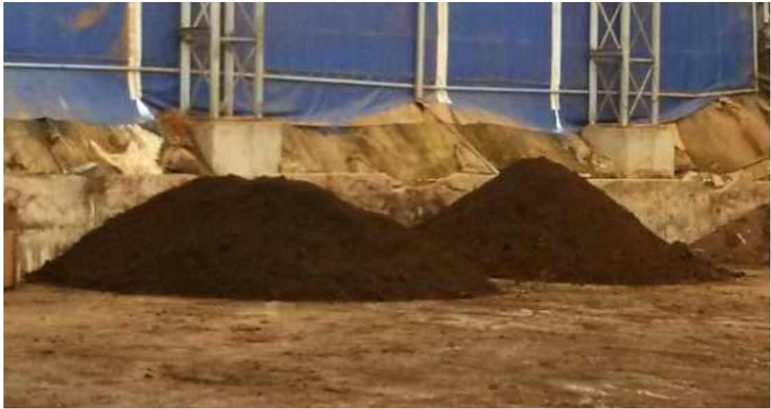
그림 48. 미생물처리에 의한 계분발효공정개선시험(좌: 대조구, 우: 미생물 처리구).
