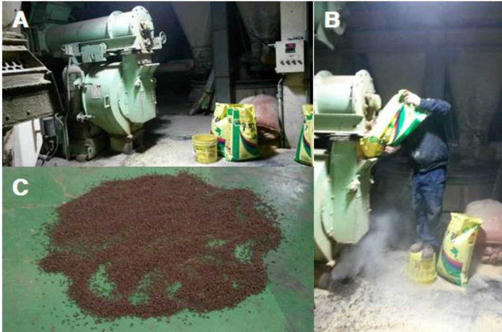
그림 58. 시제품 생산을 위한 제형화 시험. A: 제형화 장치, B: 원료투입, C: 제형 후 건조.
