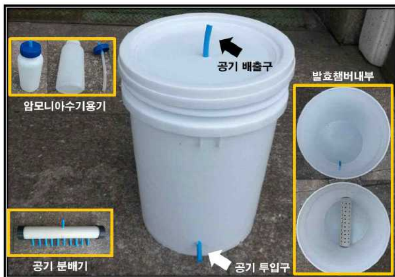
그림 7. 암모니아가스 측정용 발효챔버의 제작.
