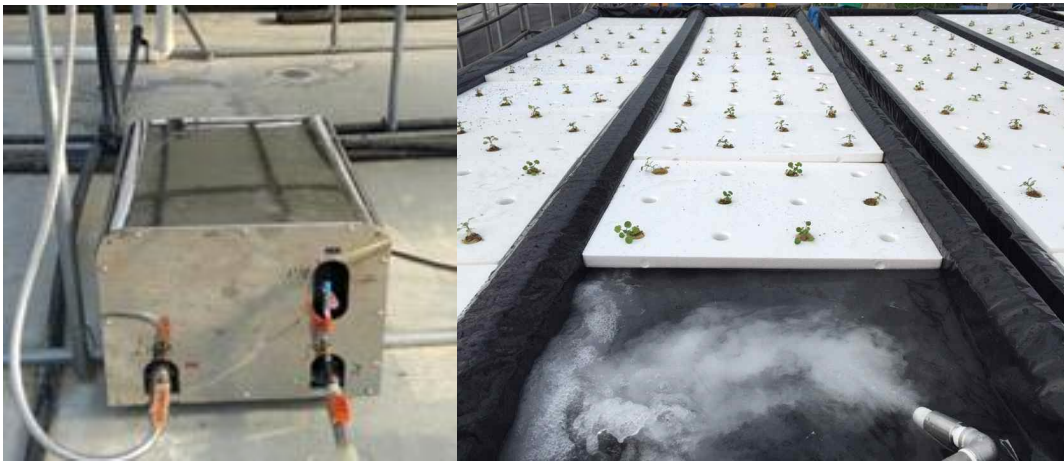
[그림36] (주)성원에서 개발한 Micro-Bubble 발생기 및 발생 사진
