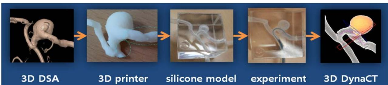
그림 19. 3D 프린팅을 이용한 실리콘 모델 제작
