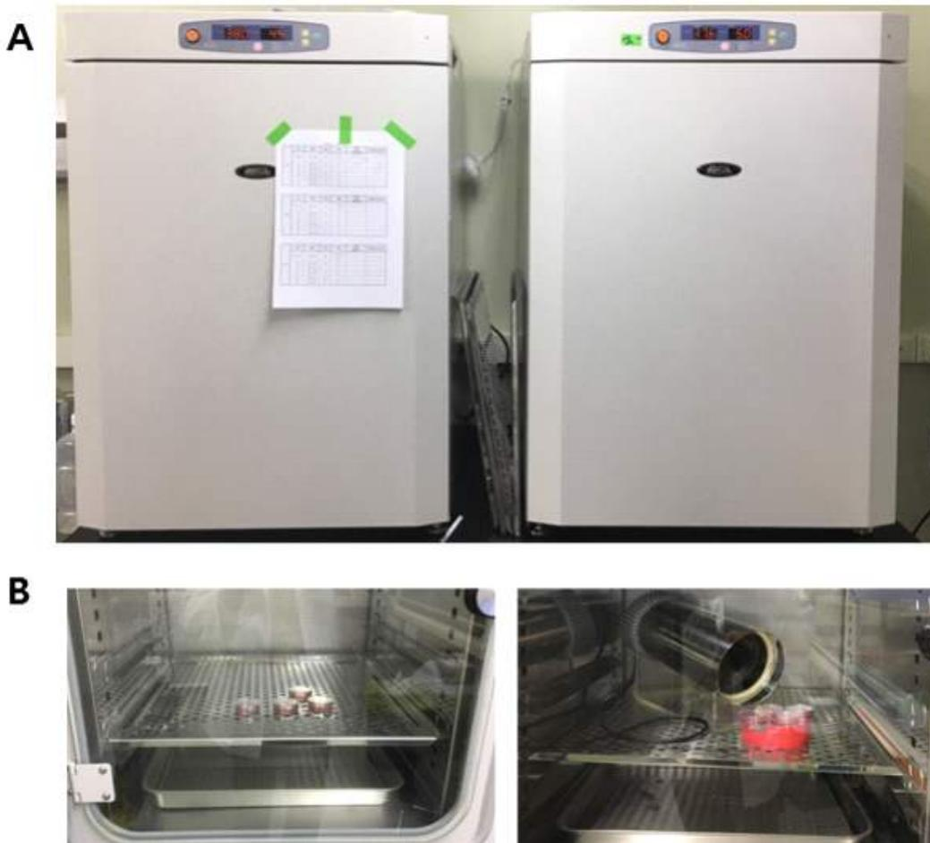
그림. 시작품 모델 (BEP) 노출에 따른 돼지피부세포 발육률 평가를 위한 위한 조건. A) 동일한 모델의 세포 배양용 CO2 인큐베이터 이용 (같은 모델, 같은 년도 출시), B) 왼쪽은 BEP가 없는 조건, 오른쪽은 BEP 노출에 따른 세포 배양 모습
