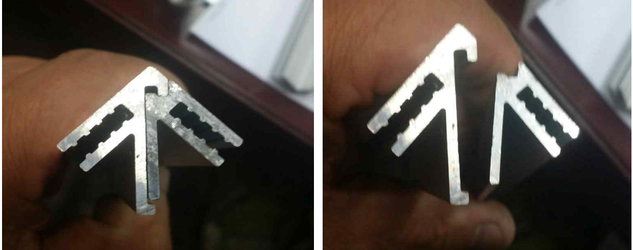
그림 3-3-23. 특허출원된 조립식 미니온실의 골격재 조립 방식.
