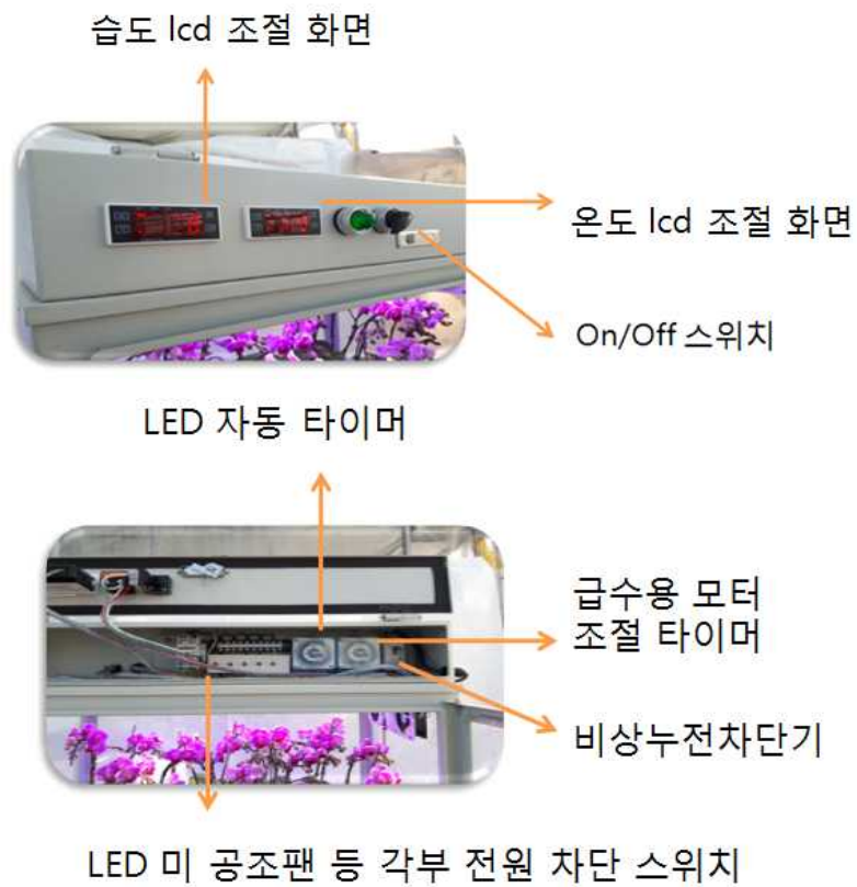
그림 3-3-26. 식물판매장치의 습도조절장치(상) 및 광/관수 조절장치.
