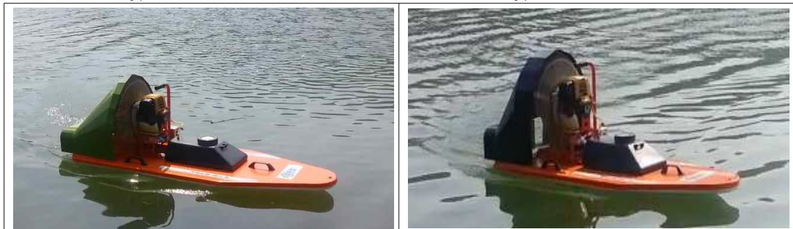
< 기존 제품에 덕트 장착 후 test >
