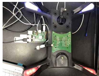
그림 41. ROS 분산 컴퓨팅을 위해 제작된 PCB기판을 드론 및 라즈베리파이와 연결
