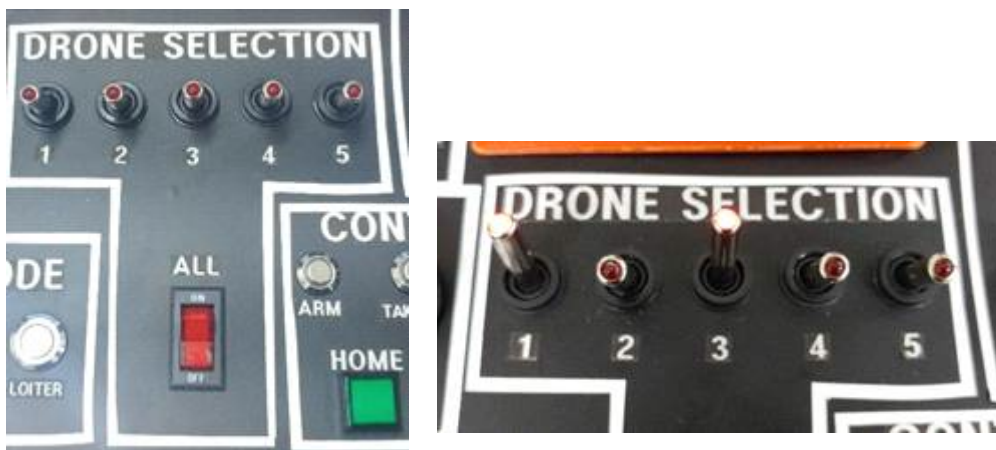
그림 59. 좌: 제어방법 선택스위치와 개별 드론 선택스위치, 우: 개별 선택된 드론 스위치 LED
