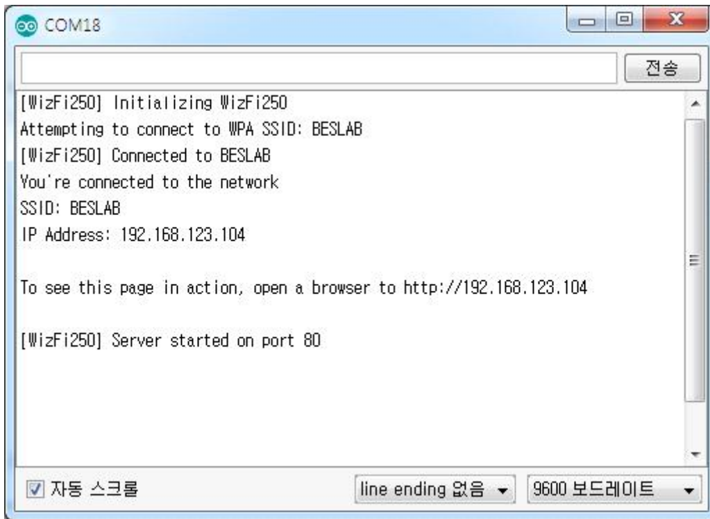
그림 63. 무선 통신 서버 접속이 이루어진 serial monitor
