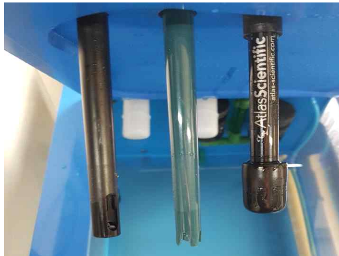
그림 76 양어부의 생육 환경 모니터링을 위한 센서 네트워크(왼쪽부터 전도도센서, pH센서, 용존산소량 센서)
