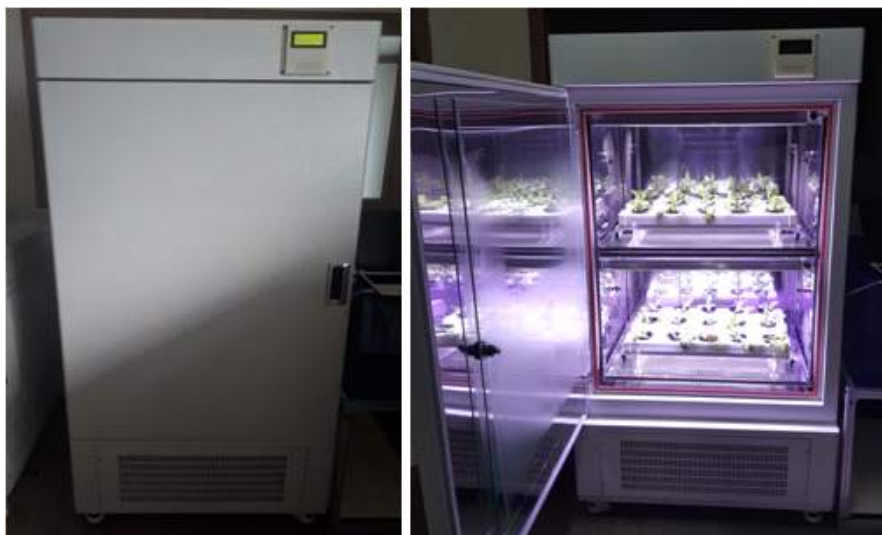
그림 87 2단 재배장치 외형 및 내부
