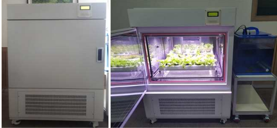
그림 86 1단 재배장치 외형 및 내부
