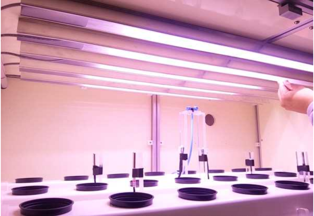
그림 47 설계된 반사판을 적용한 LED어레이를 식물재배부에 설치
