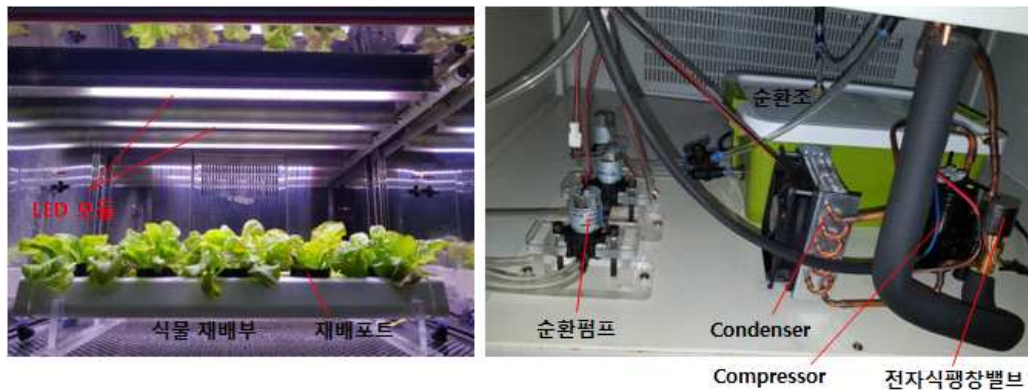
그림 91 재배장치 주요 구성 품
