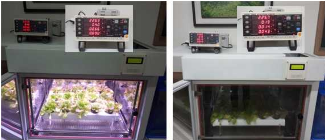
그림 92 재배장치 주간 및 야간 가동 소비전력 측정
