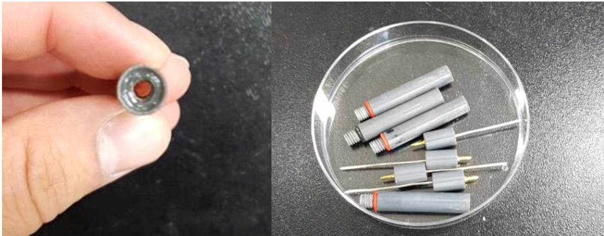
그림 79 질산염 측정을 위해 제작된 이온선택성 전극 몸체
