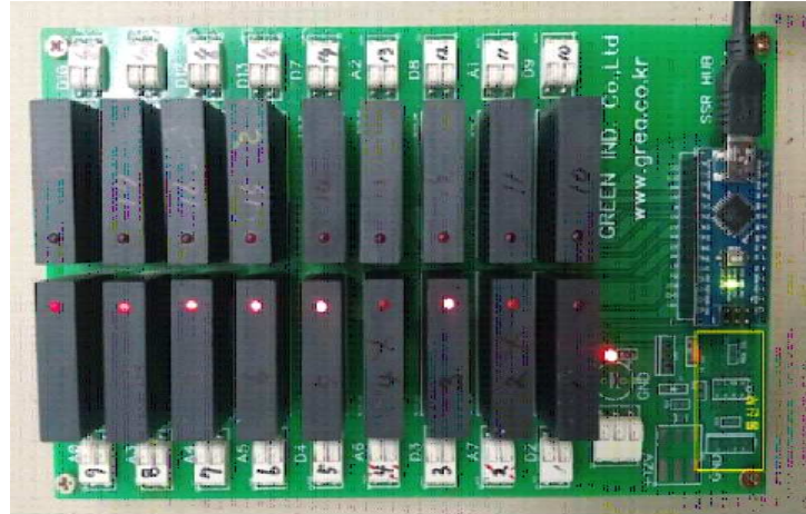
그림 37 . AC 제어부 PCB
