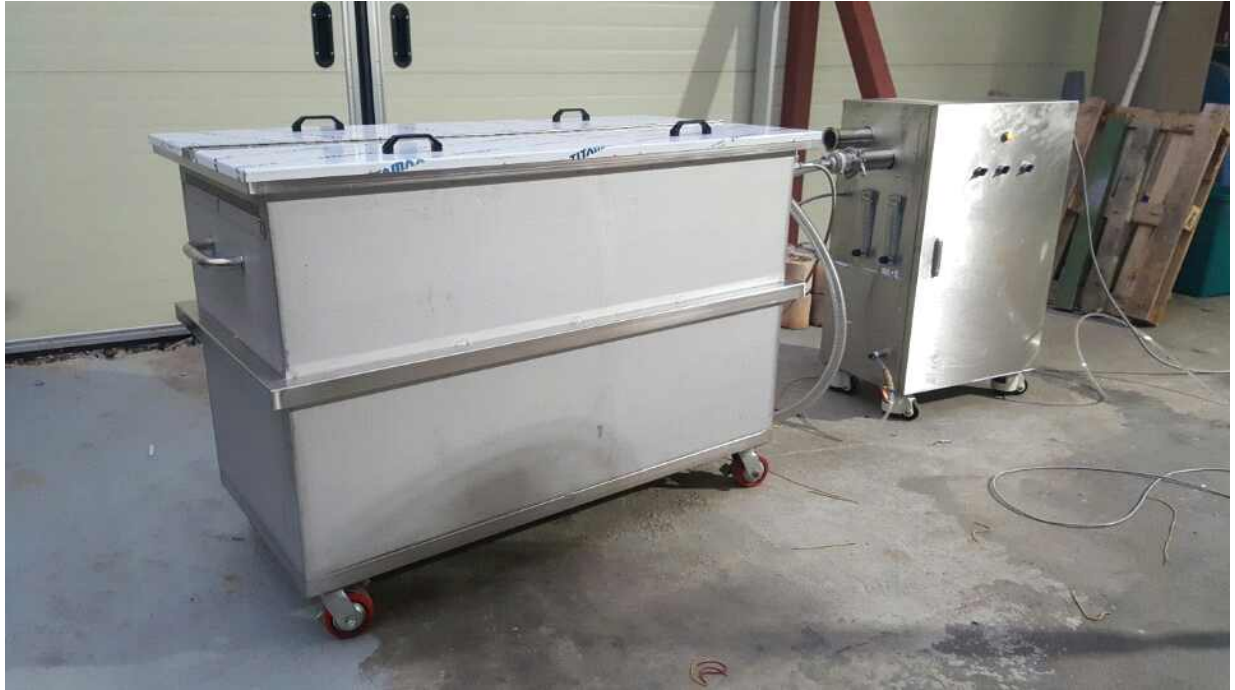
Fig. 7. 식육부산물 위생처리를 위한 시험용 오존수 제조 장치의 시제품
