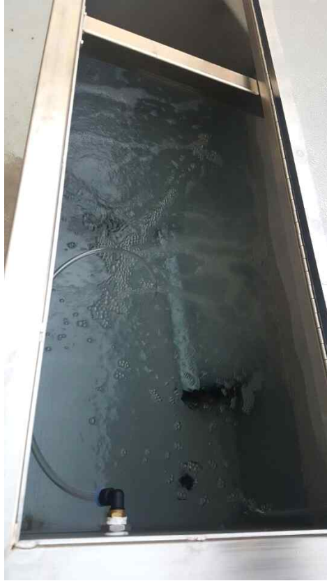
Fig. 8. 식육부산물 위생처리를 위한 시험용 오존수 제조 장치 시제품의 정상 작동 모습
