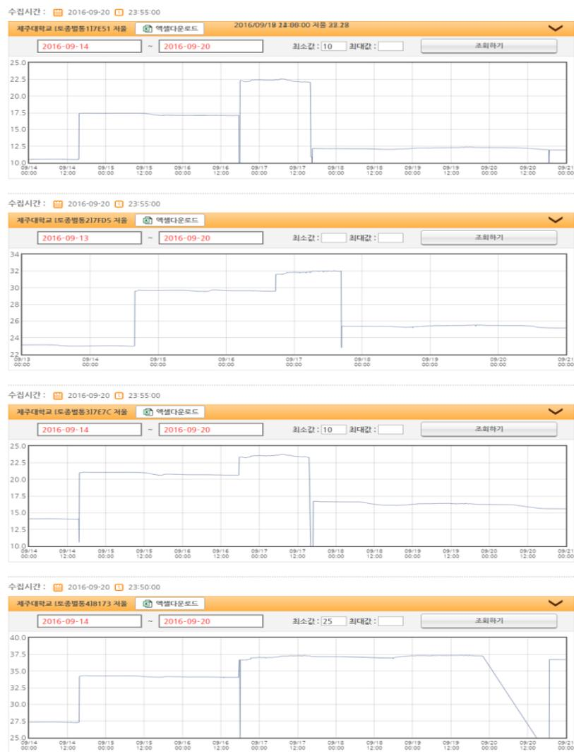
그림 40 토봉 사육상의 중량변동. 관리를 위하여 증소 등의 처치에 따른 큰 폭의 중량변동과 증체의 증식 및 유밀의 정도에 따른 일간 변동 값을 확인 할 수 있다.
