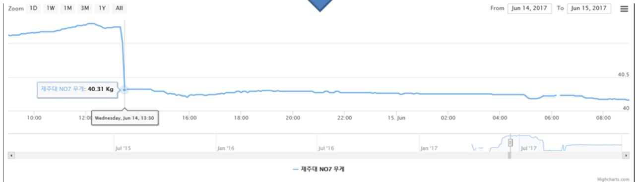
그림 39 분봉직후 무게의 급격한 감소 41.24kg → 40.31kg
