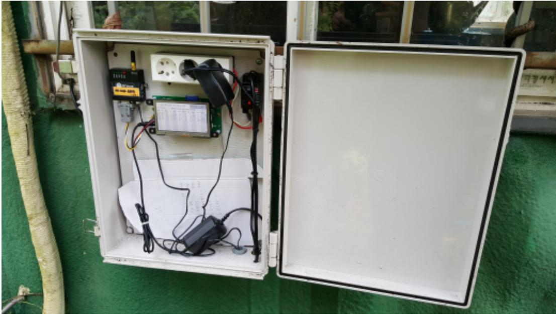
그림 14 데이터 수집 및 전송장치 설치. 선행연구의 결과물을 적용하였다.
