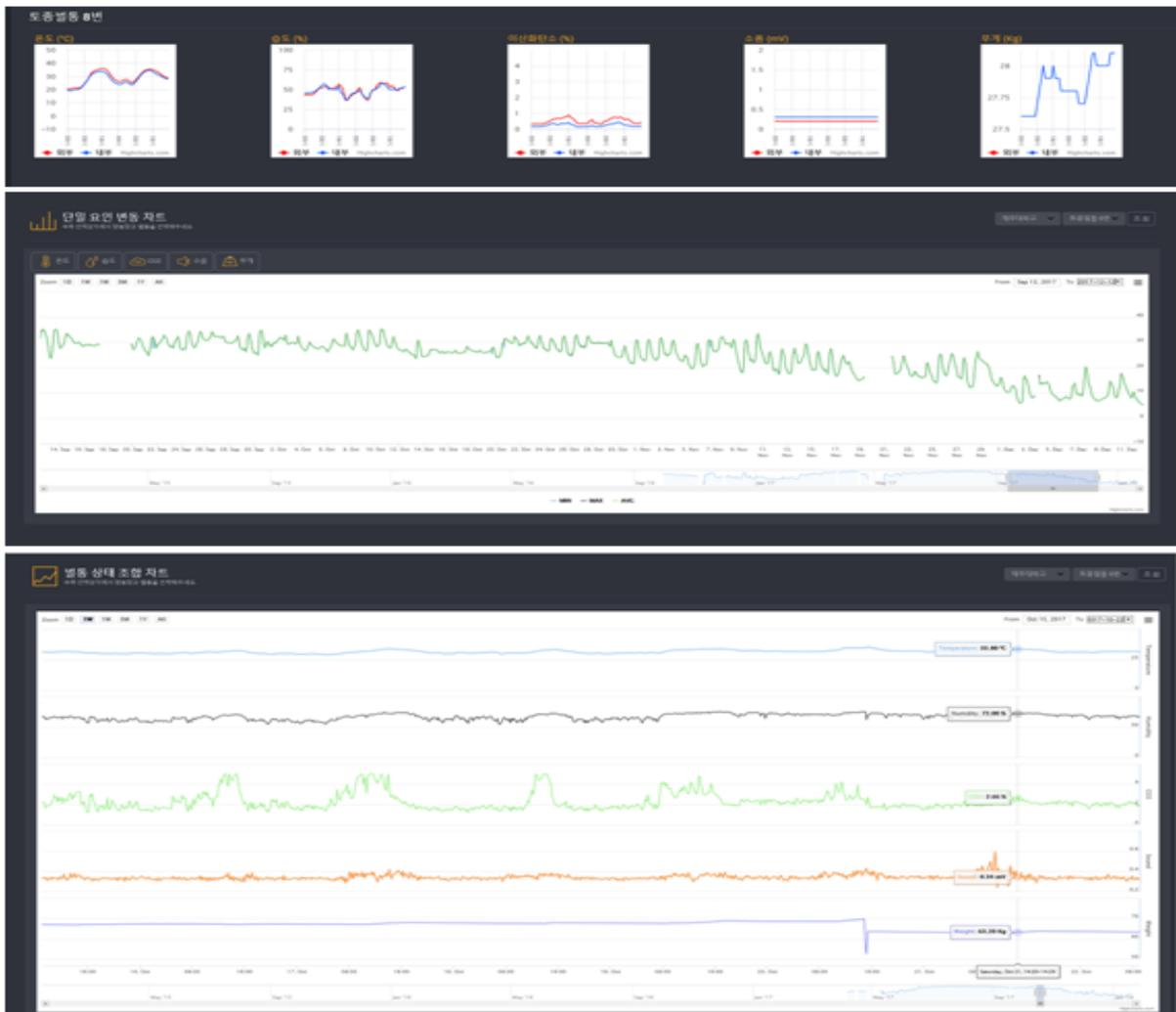
그림 19 모니터링 웹사이트 인터페이스. 상단 : 별통에서 수집된 현 시점의 환경인자를 한눈에 나타내는 Dashboard, 중단 : 단일 환경인자의 평균값, 최대값, 최소값을 나타내는 단일요인변동차트, 하단 : 별통에서 수집된 모든 환경인자를 상세하게 나타낸 상태조합 차트
