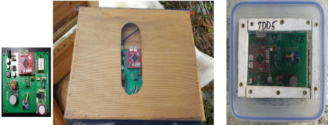
그림 15 센서디바이스와 케이스. 케이스는 토봉용 사양기의 규격에 맞도록 제작한 후, 방충망을 적용하여 제작하였다(중). 재래식 토봉사육상 적용을 위한 케이스, 밀폐용기와 방충망을 적용하였다(우).
