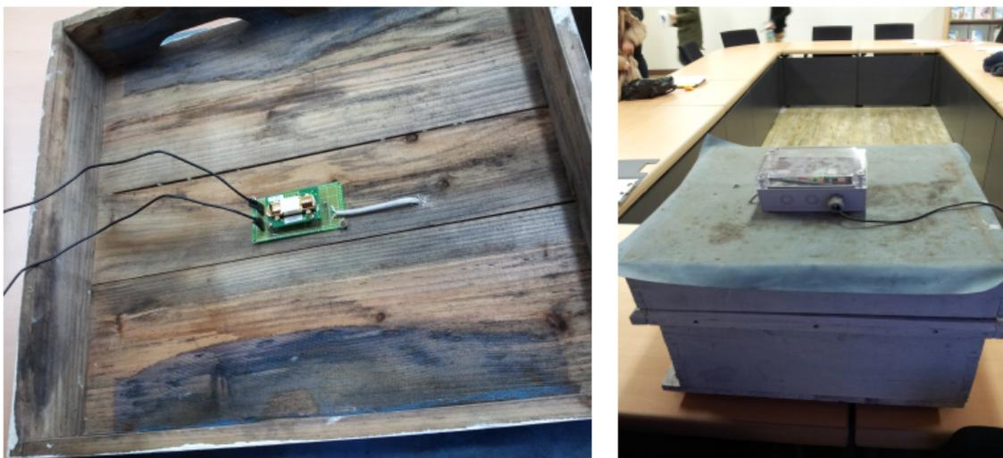
그림 2 초기 prototype 센서 디바이스
