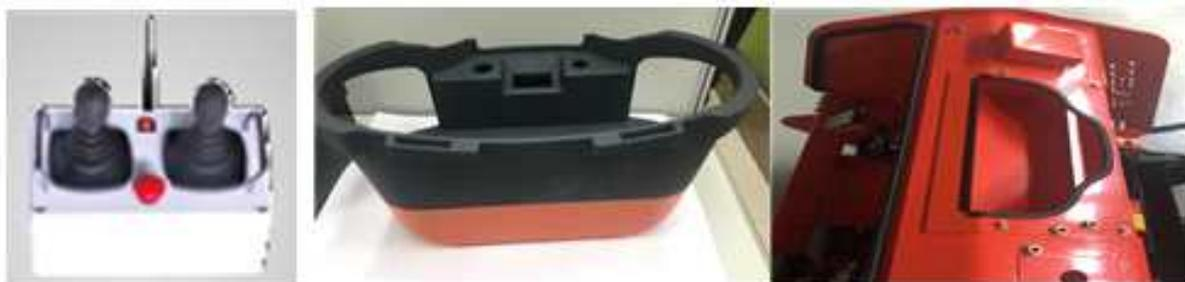
그림 52 작업대 조작 패널 제작 (착탈 가능)
