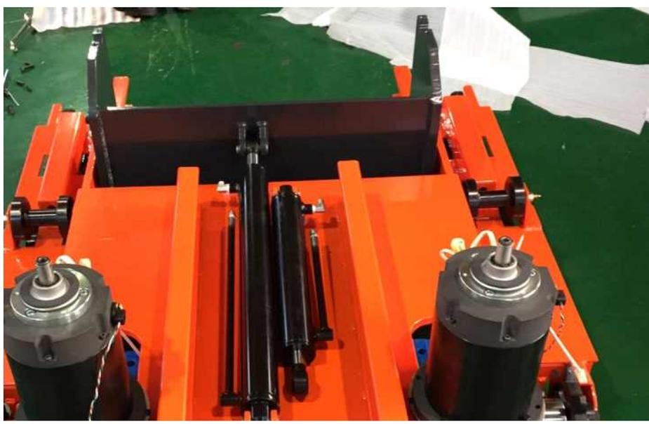
그림 37 포크 및 프레임 가변장치 제작
