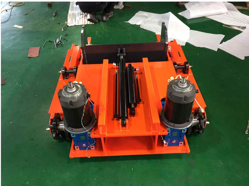
그림 34 모터 및 감속기 조립
