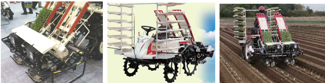
그림1-13. 승용 자동 2조 정식기 플랫폼 개발
