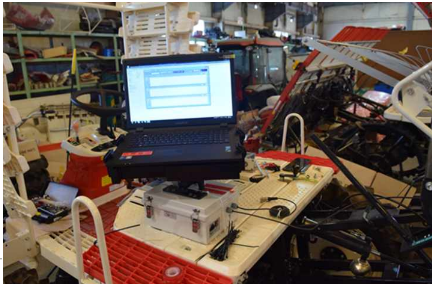
그림3-29. 컨트롤박스 및 노트북으로 구성된 DAQ 시스템
