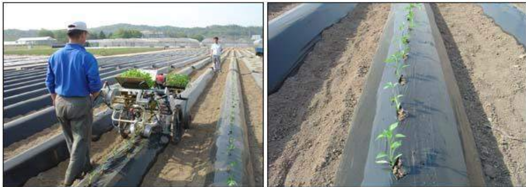
그림1-22. 포장성능 시험평가 (채소정식기의 예)
