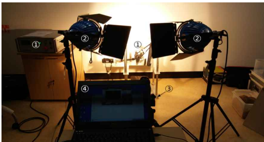
① 토양저항 측정 장치 ② 촬영용 조명 ③ 초고속 카메라 ④ 계측용 노트북 그림3-110. 토양저항 측정 및 초고속카메라를 이용한 이식호퍼 궤적분석 시스템
