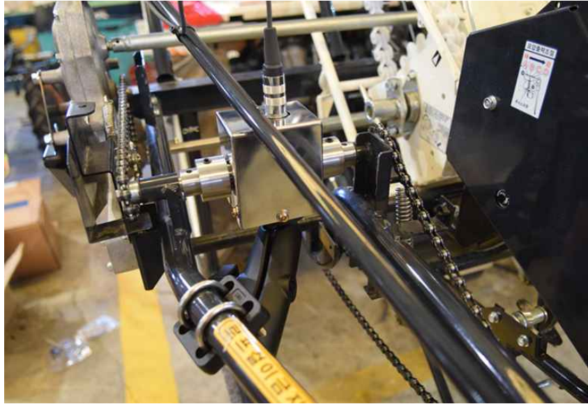
그림3-22. 정식기 횡 이송축에 설치된 토크센서
