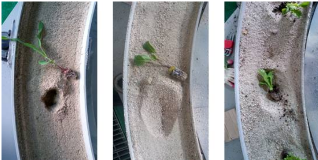
그림3-129. 비교기대 이식호퍼 실험간 발생한 육묘의 결주 모습
