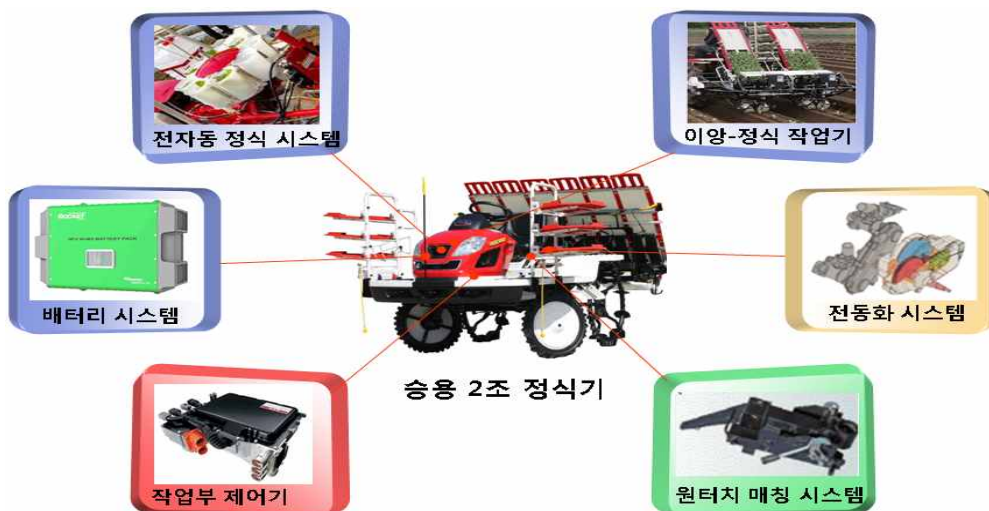
그림1-11. 승용 자동 정식기 및 전동화 작업 시스템 구성 요소
