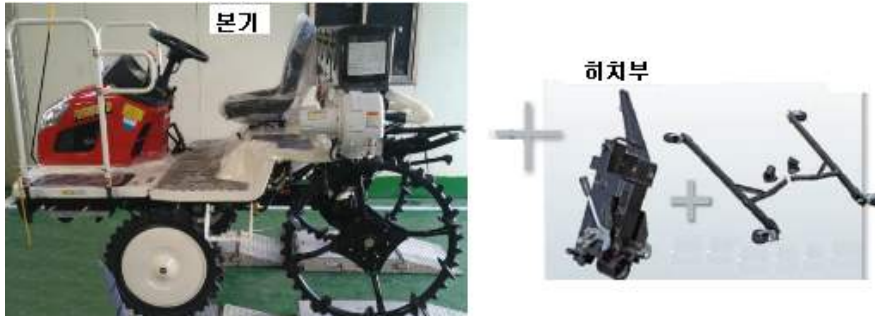
그림1-14. 승용 자동 2조 정식기 플랫폼 개발
