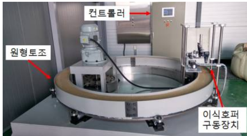
그림3-125. 이식호퍼 성능평가용 원형토조 실험장치
