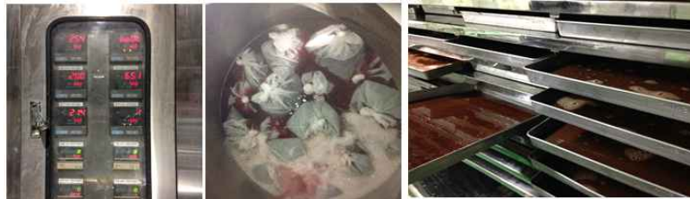
그림 1. 오미자 추출 공정(추출과 동결 건조 과정)
