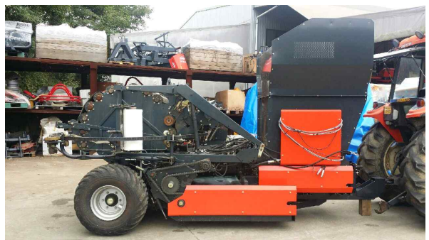
(d) Temporary storage tank & Integrated baler
