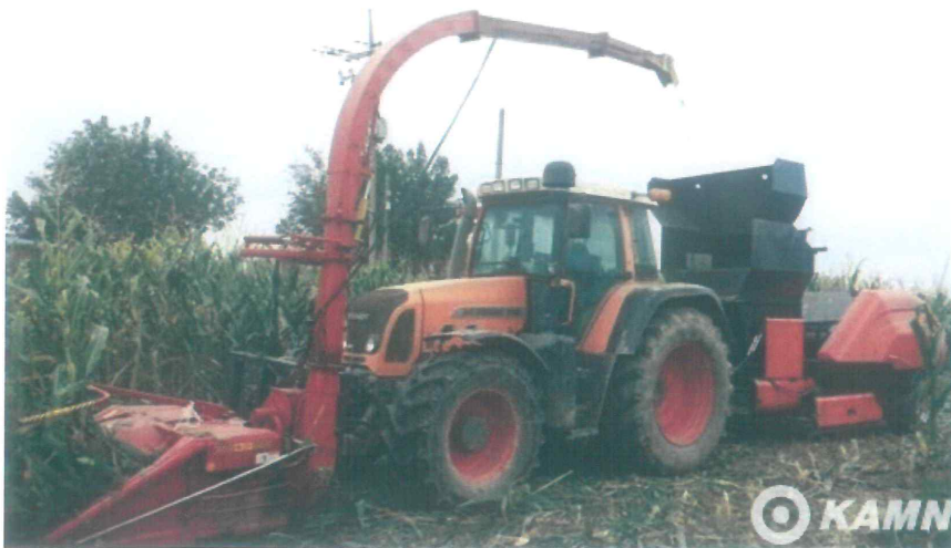
▲ (주)명성이 1대의 기계로 수확, 베일성형, 비닐랩핑 작업을 할 수 있는 사일리지 조재기를 개발했다.
