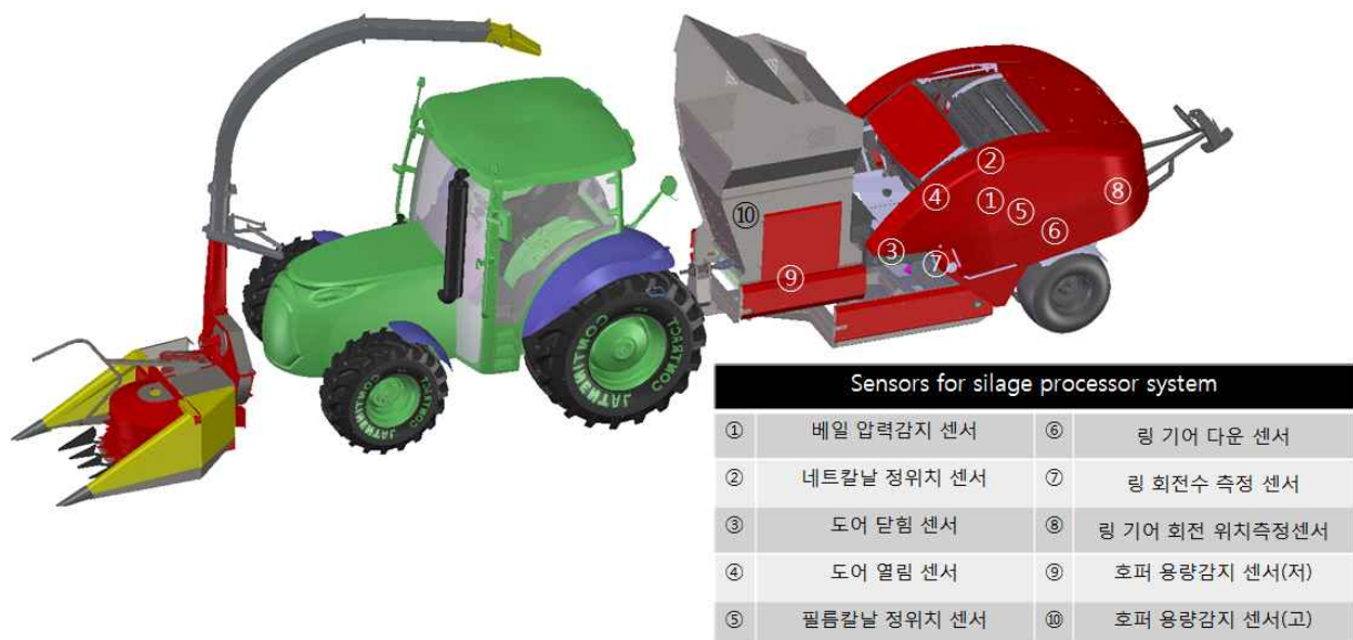
Figure 1. 1차년 시작기에 적용된 센서 구성 및 설치위치
