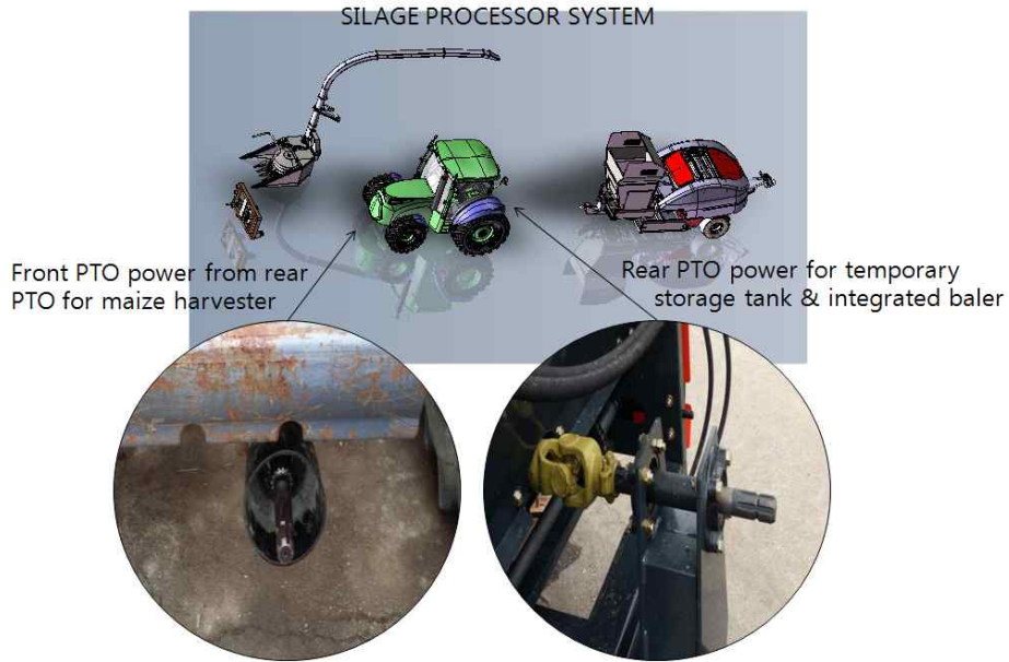
Figure 2. 1차년 시작기의 트랙터 PTO장치 구성 및 설치위치
