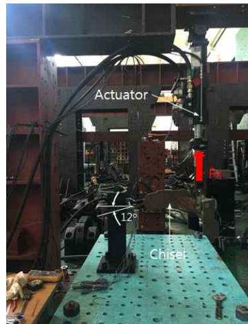
<그림2.33> 치즐의 시험설치 사진
