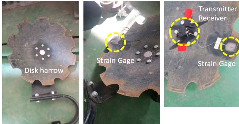
<그림2.28> 디스크 해로우 내 스트레인 게이지 및 트랜스미터 부착
