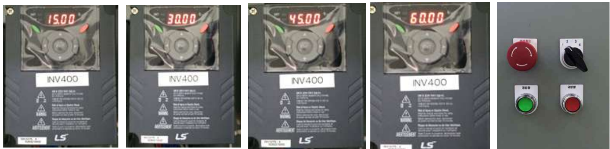
<그림 1.8> 실험동 내 Soil-bin 이송장치 속도 제어.
