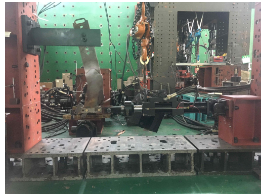
<그림2.81> 치즐 피로시험설치 개략도 및 피로시험장면
