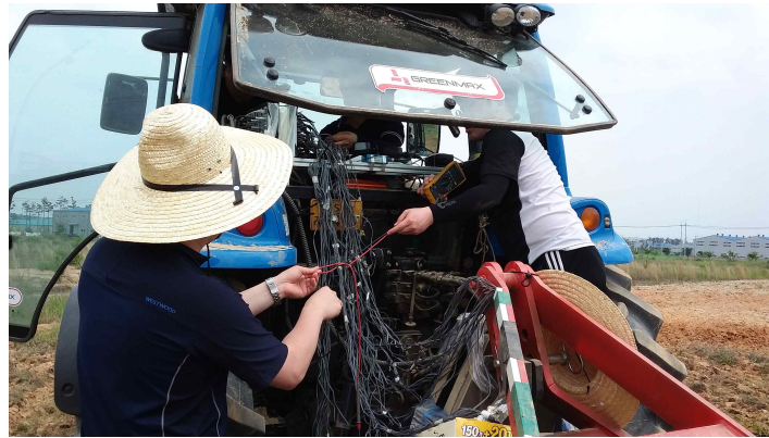
<그림2.45> 스트레인게이지 전선을 데이터 측정장비에 결선하는 장면
