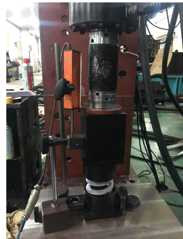
<그림2.83> 디스크 해로우 스프링의 피로시험장면
