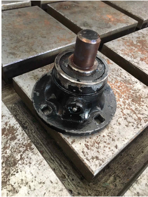
<그림2.92> 시험 종료후의 디스크 해로우 허브 베어링의 사진
