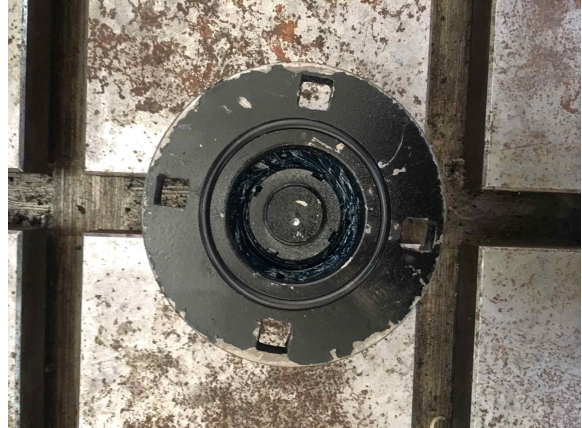
<그림2.92> 시험 종료후의 디스크 해로우 허브 베어링의 사진
