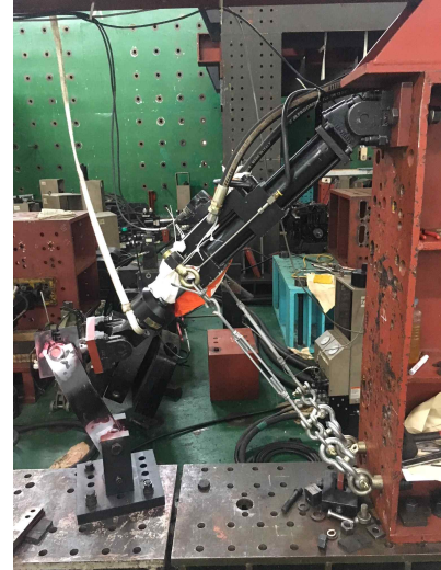
<그림2.78> 디스크 해로우 피로시험설치 개략도 및 피로시험장면
