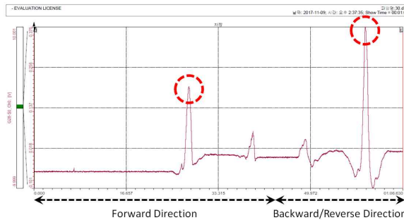
<그림3.8> 이송 속도가 약 0.3 m/s 일 때 응력 신호 값 측정
