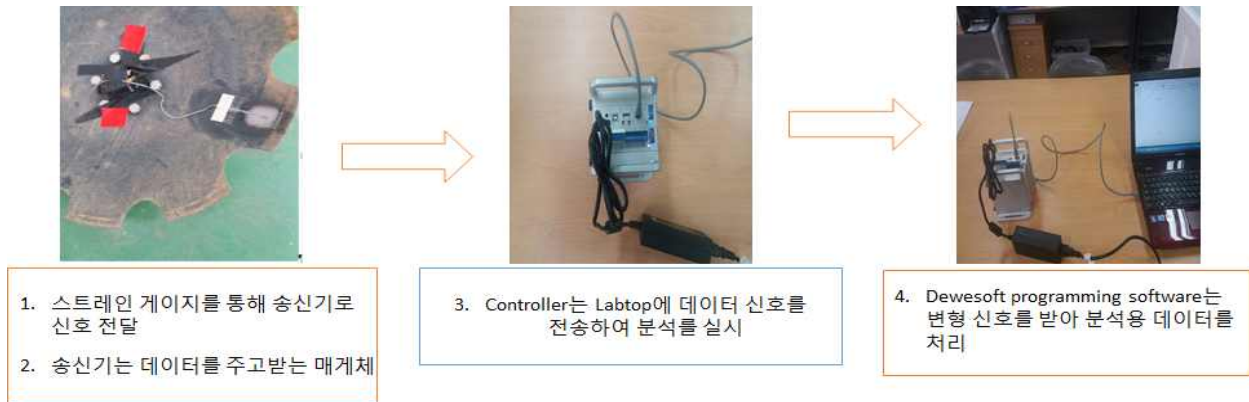
<그림2.29> 응력 신호 수집 개념도
