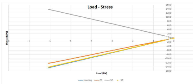
〈그림2.34〉 치즐 C#1 시험체 정하중시험 결과
