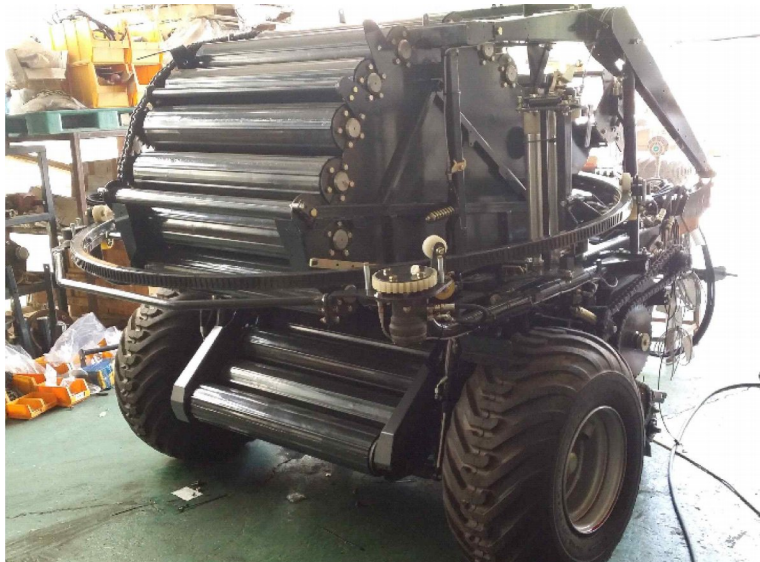
《 1차년 시작기 본체 조립 (커버 제외 상태) 》
