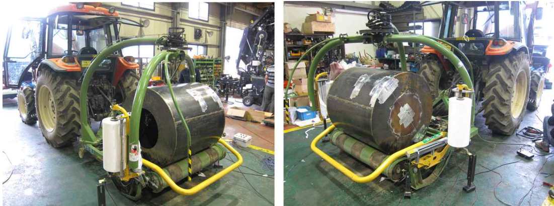
Figure 4. 요인시험을 위한 센서 설치 상태
