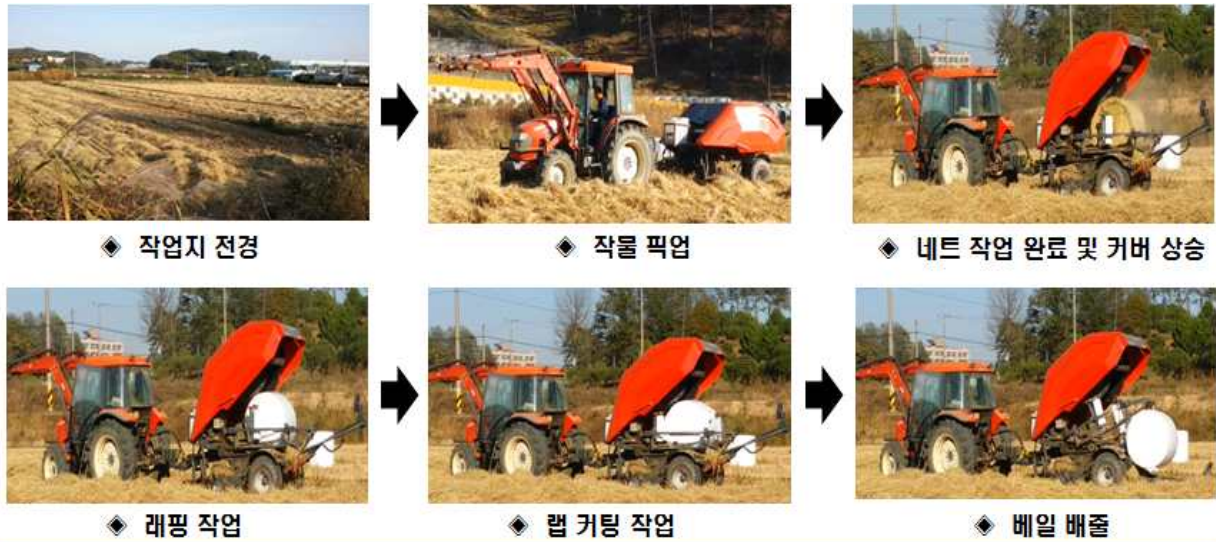
Figure 1. 엔지니어링 샘플기 현장실증실험 기본 작업공정
