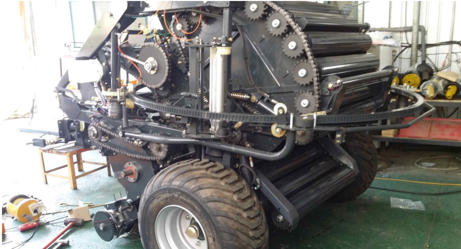
《 롤러부 구동 동력부 연결 제작 및 조립 》
