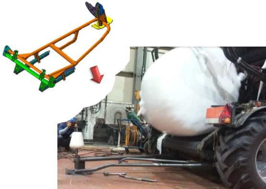
Figure 1. 베일 수직세움 요인시험장치 제작
