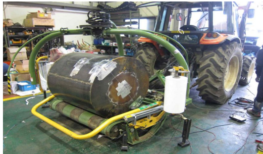
위치센서 및 압력센서 설치
