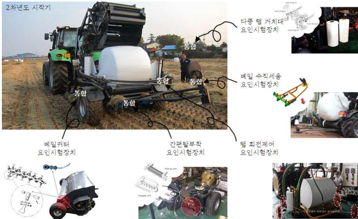
Figure 15. 2차년 시작기에 통합된 주요 요인시험장치
