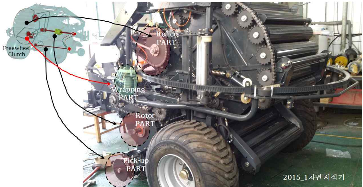
Figure 3. 다목적 베일러 동력전달 체계도 및 1차년 시작기
