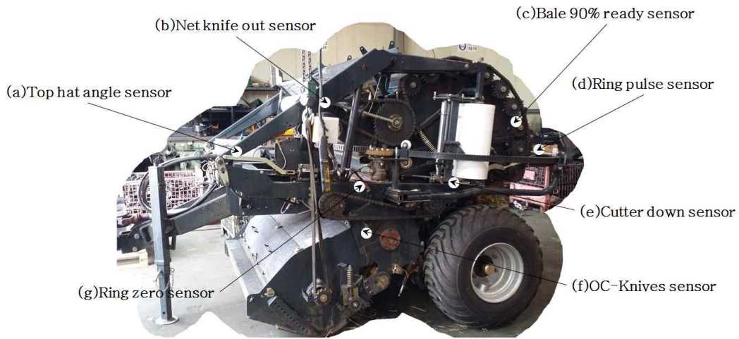
Figure 5. 2차년 시작기의 각 센서 설치위치 및 센서명칭 (상부커버 조립 전)
