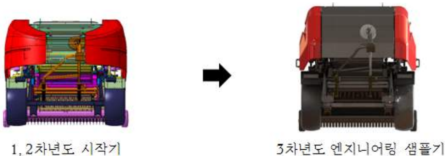
Figure 2. 엔지니어링 샘플 최저 지상고 변경
