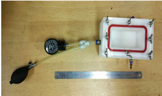
Lab 센서(FSR406) 초기화 사용, 압력챔버
