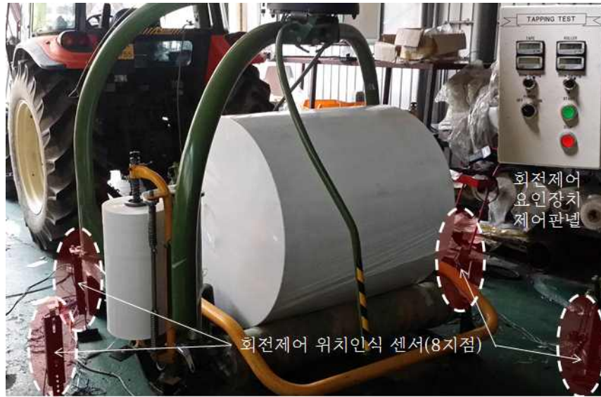
Figure 1. 랍 회전제어 요인시험장치 제작
