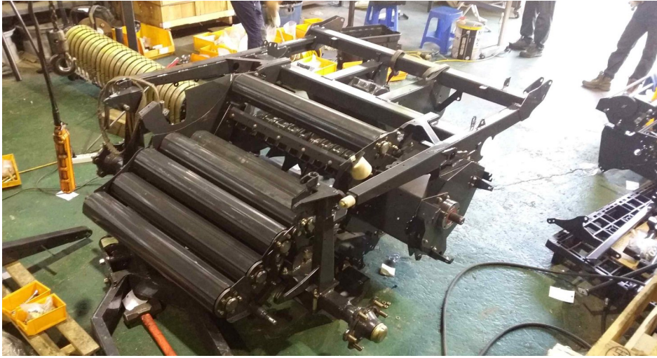
《 상부 롤러부 어셈블리 제작 및 조립 》
