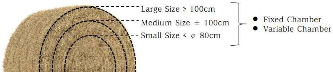
Figure 3. Bale의 직경에 따른 Baler 분류
