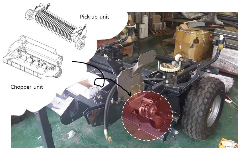
Figure 3. 간편 탈부착 장치의 픽업유닛(L), 초파유닛(R) 성능평가 개념도
