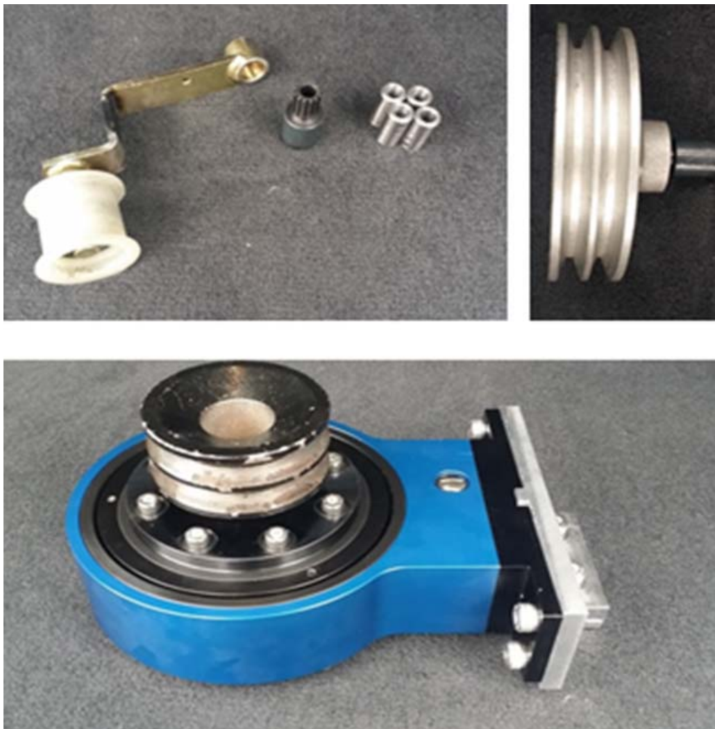
그림 151. 계측 시스템 주요 부품 (미션 스플라인, 미션 폴리, 토크센서)
