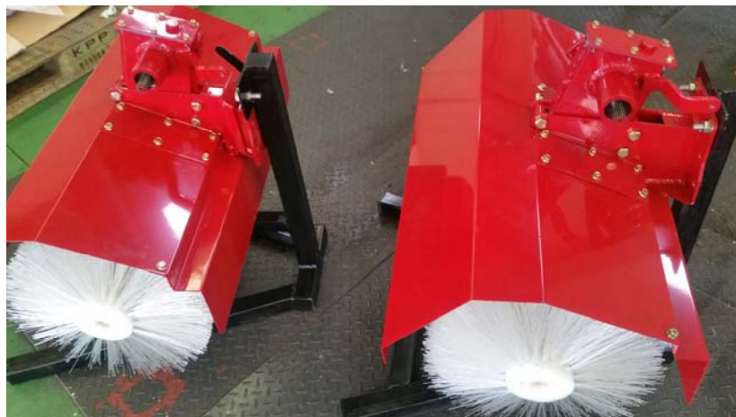
그림 145. 브러쉬청소기 본체 및 PTO 연결부 참조
