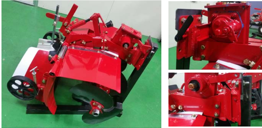
그림 140. 휴립작업기 본체 및 PTO 연결부
