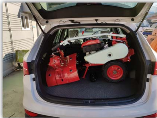
그림 212. 트럭이 아닌 SUV 탑재 이동 가능토록 컴팩트 구조 실현
