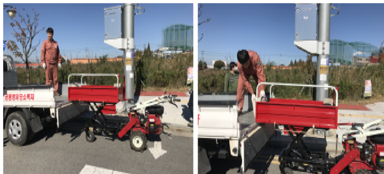
그림 102. 리프팅 기능 테스트
