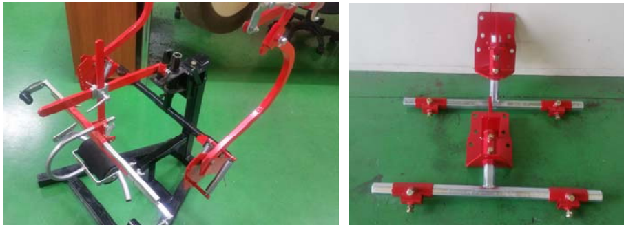
그림 141. 피복작업기 본체 및 프레임
