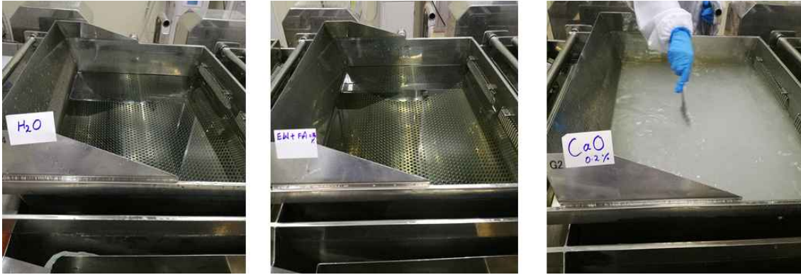
Fig. 4-6. 현지 공장 세척 수조에서 친환경 살균제 제조하는 모습(b)
