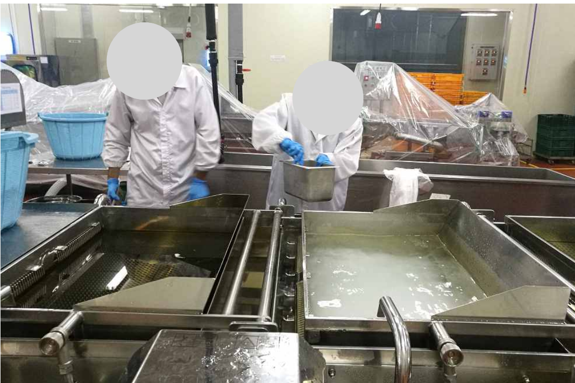
Fig. 4-6. 현지 공장 세척 수조에서 친환경 살균제 제조하는 모습(a)
