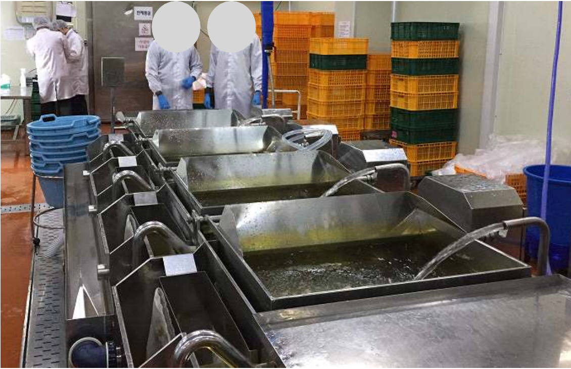
Fig. 4-5. 현지 공장에서 사용 중인 세척 수조에 수돗물을 채우고 있는 모습
