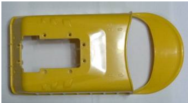
[그림 37. 안전커버 1차 개발품 형상설계 및 금형 제작]
