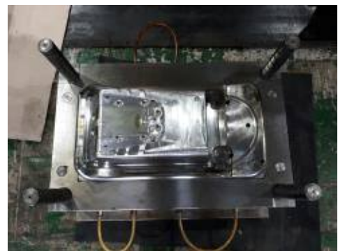
[그림 37. 안전커버 1차 개발품 형상설계 및 금형 제작]
