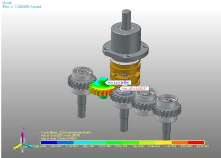
[그림 56. 기어 파트 FFLEX 해석 결과(최대 변형)]
