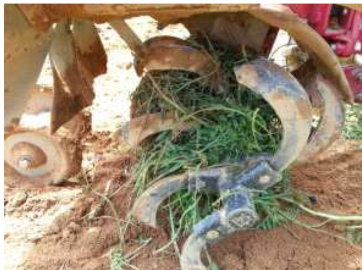
[그림 4. 로터리 방식의 축감김 현상]
