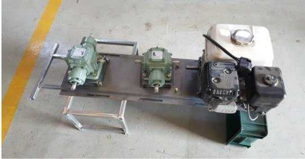
[그림 85. 프레임 상부 엔진 기어박스의 위치]
