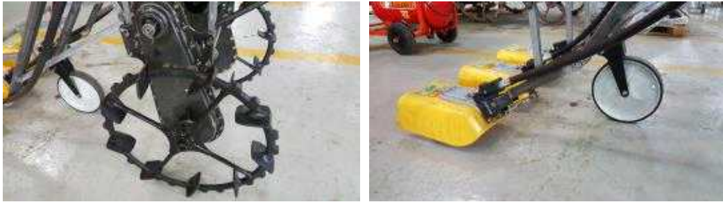
[그림 88. 주행 메인바퀴과 보조바퀴 조립]
