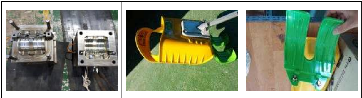
[그림 44. 플로우팅 시금형 제작 및 시제품 제작]
