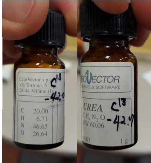
그림 23. \delta^{13}\text{C} 측정용 표준물질
