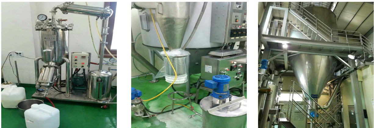
그림 9. 산양유 단백질 분획물(A2 β-케이신)의 농축 및 분무설비. 농축기(좌), pilot 분무건조기(가운데) 대량생산용 분무건조기(우)
