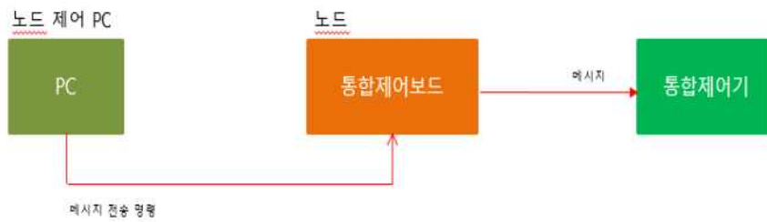
통합제어시스템_데이터 획득장치(통합제어보드)메시지 전달 시험 구성도
