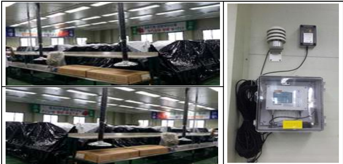
그림 46. 선별장내 환경 모니터링 시스템 설치
