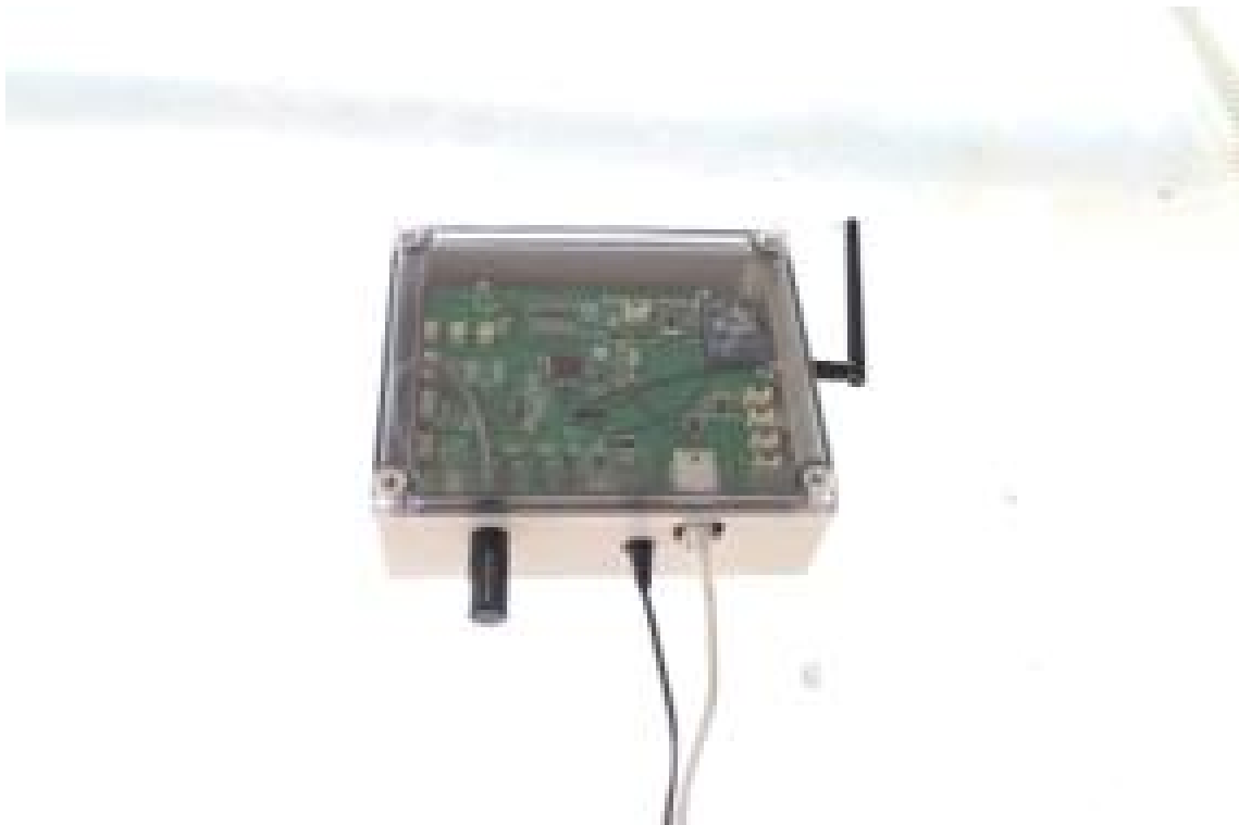
그림 1-110. KCTHI Node-VER1.0를 이용한 ethernet 연결부
