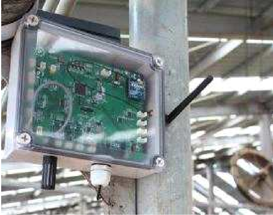
그림 1-113. KCTHI Node-VER1.0를 이용한 온습도 및 내부우사 측정 센서 장비 확대모습
