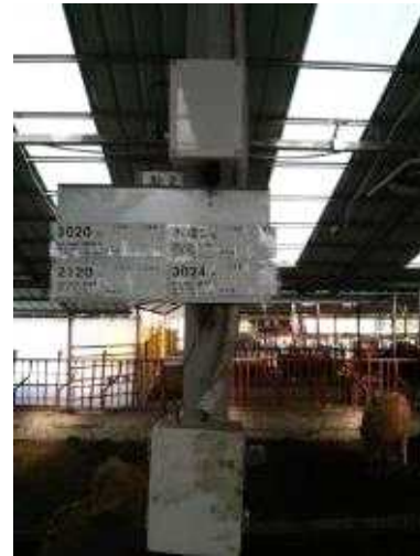
그림 1-46. 소음 측정기. 동물들의 울음소리 및 기타 발생하는 소음 값들을 실시간으로 측정하였다. 설치위치는 스텐 촌 방향에 설치하였음.
