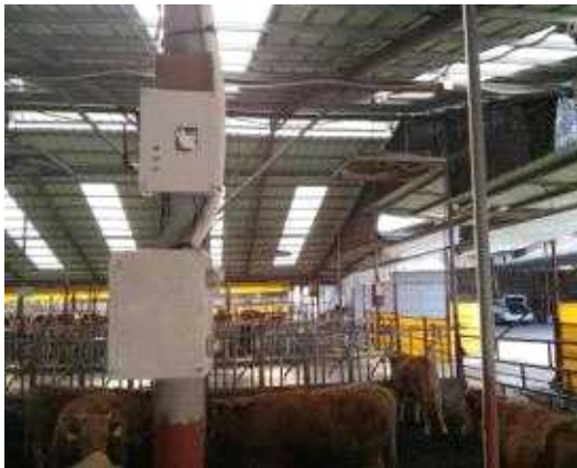
그림 1-45. 온·습도 및 이산화탄소 측정기, 온·습도 일체형과 휴대용 이산화탄소 측정기를 하나로 합쳐 설치 실시간 측정하였음. 설치 위치는 스텐 촌 반대편 번식우들이 휴식을 많이 취하는 곳 위쪽임.
