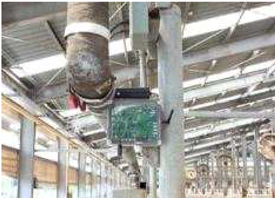
그림 1-112. KCTHI Node-VER1.0를 이용한 온습도 및 내부우사 측정 센서 장비
