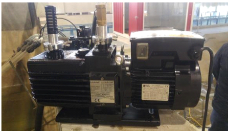
<그림 6-24> 진공펌프를 활용한 초기작동 시험
