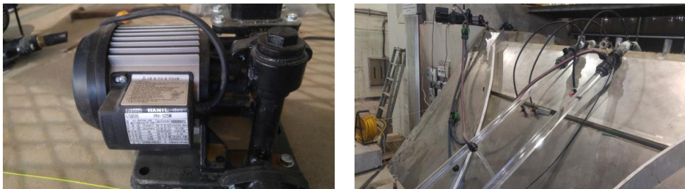
<그림 6-25> 양수펌프를 활용한 초기작동 시험
