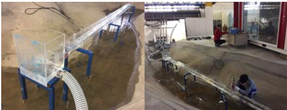
<그림 6-22> 유출부 감세실험 전경
