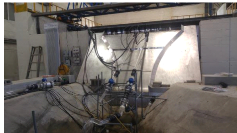
<그림 6-24> 진공펌프를 활용한 초기작동 시험
