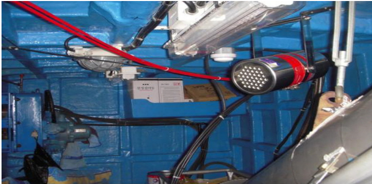
〈그림 4-2〉 자동 소화 시스템 설치 사례
