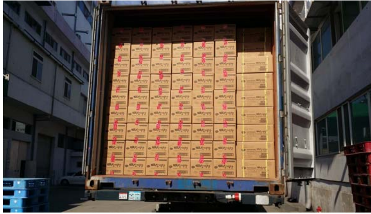
그림 41. 장 방향으로 11줄-19줄, 폭 방향으로 7열, 고 방향으로 8-9단 적재.
