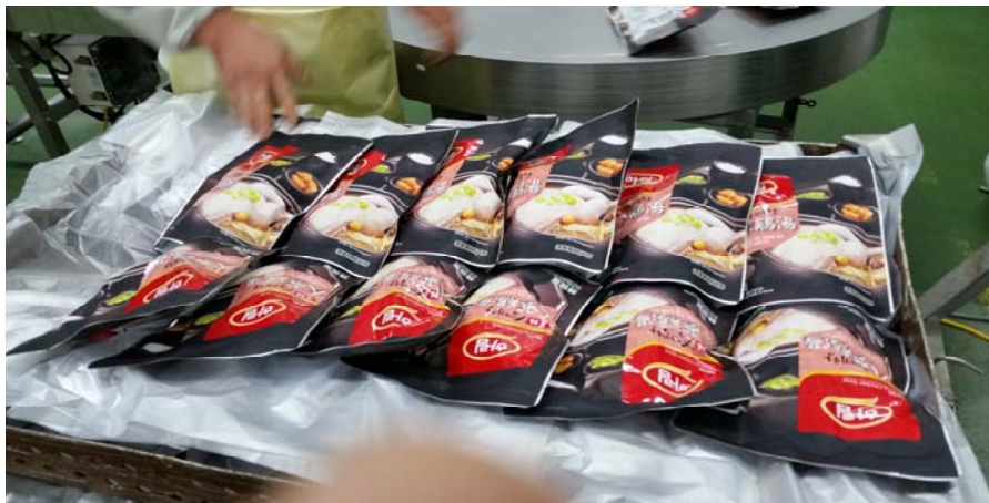
그림 30. 잉크 전사를 방지하기 위해서 삼계탕 제품 사이에 필름을 까는 모습-2.
