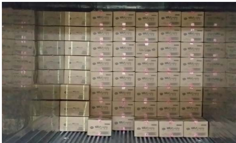
그림 45. 장 방향으로 26-33줄, 폭 방향 6열, 고 방향 7-8단 총 1,200박스 적재.
