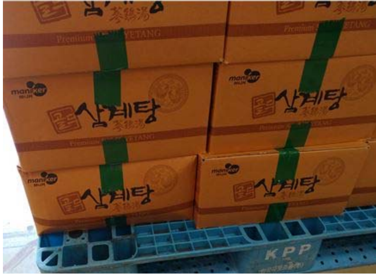
그림 75. 진동시험 후 최하단 상자에서 찌그러짐 현상 관찰.
