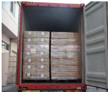
그림 35. 파렛트 화물 적재(좌: 파렛트에 7단 적재 - 6단 적재가 적정수준, 우: 컨테이너 내에 스트레치 랩핑 상태로 적재).
