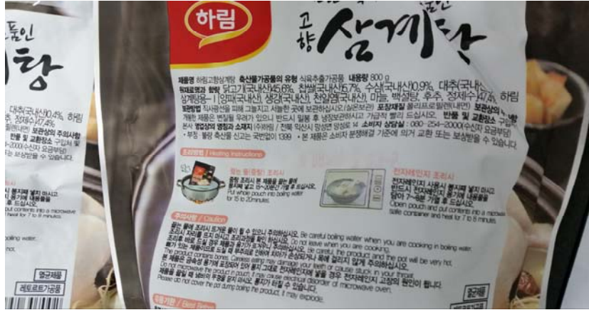
그림 28. 삼계탕 포장재에 프린트된 일부 표시가 다른 포장재로부터 전사된 모습.
