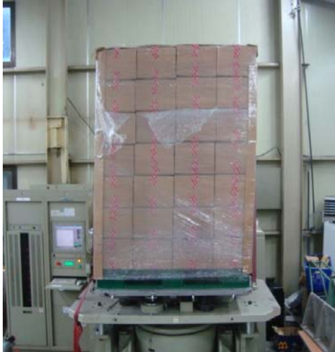
그림 36. 삼계탕 파렛트 화물 진동시험(좌: 삼계탕 포장파렛트 화물 진동시험, 우: 진동시험 컴퓨터기록).
