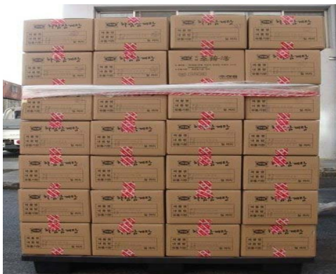
그림 35. 파렛트 화물 적재(좌: 파렛트에 7단 적재 - 6단 적재가 적정수준, 우: 컨테이너 내에 스트레치 랩핑 상태로 적재).
