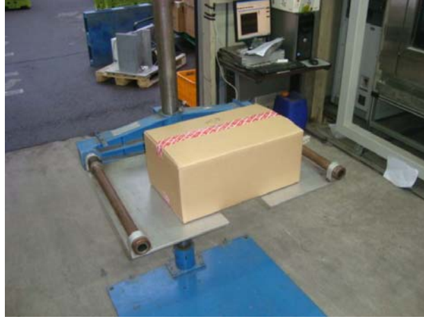
그림 37. 삼계탕 수출포장상자 낙하 시험
