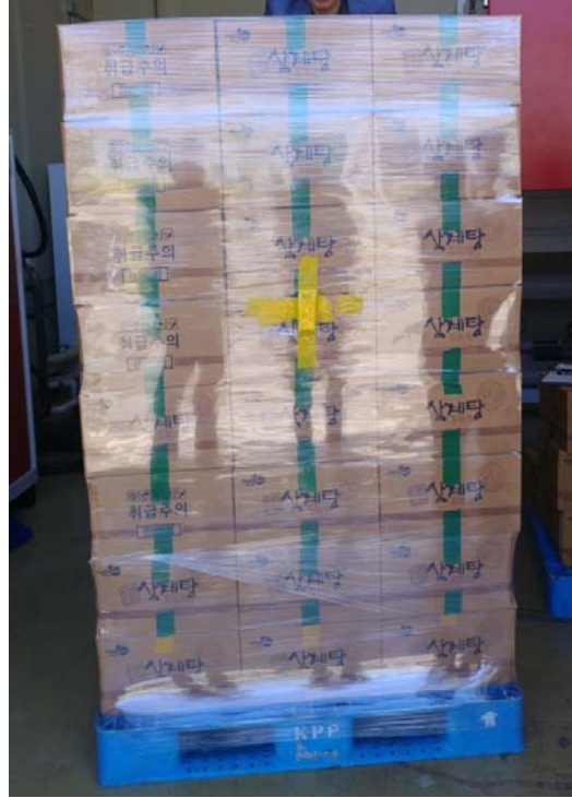
그림 70. LLDPE 필름으로 2겹으로 랩핑작업하여 화물 고정.
