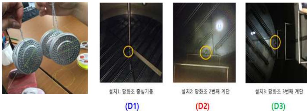
Fig. 2-5. 홍삼맥주 제조 시설 중 5t 당화조에 데이터 로거를 설치한 모습
