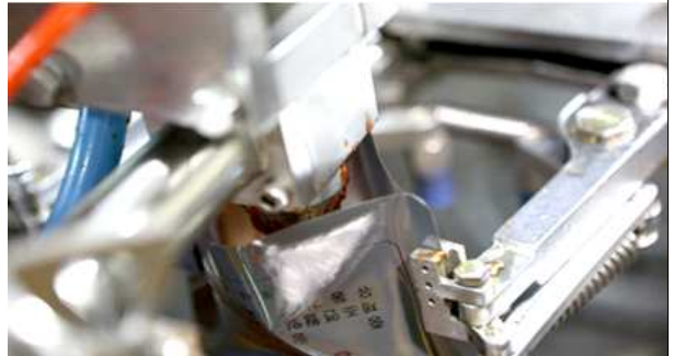
06 충전오토실링기를 이용하여 충전 및 밀봉
