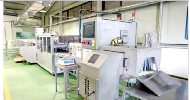
08 검사 및 포장육안선별(핀홀) 및 X-Ray 이물 검출기를 이용하여 제품 포장
