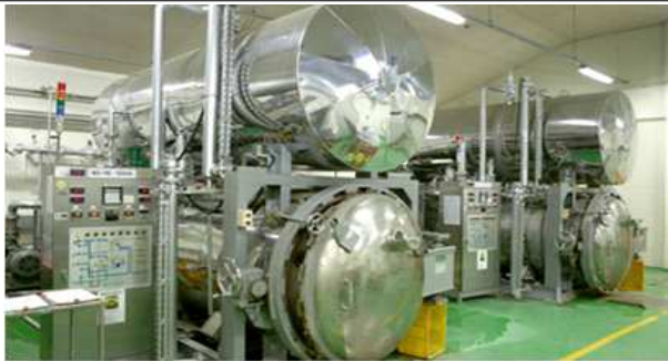
07 멸균 및 냉각완성된 제품을 고압멸균기(증기식, 열수식)으로 처리
