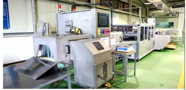
04 검사 및 포장육안선별(핀홀) 및 X-Ray 이물 검출기를 이용하여 제품 포장
