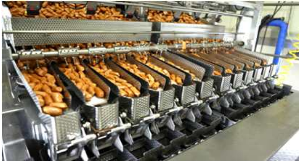
05 계량/충진혼합된 원료를 자동계량 및 오토실링기를 이용하여 충전 및 밀봉
