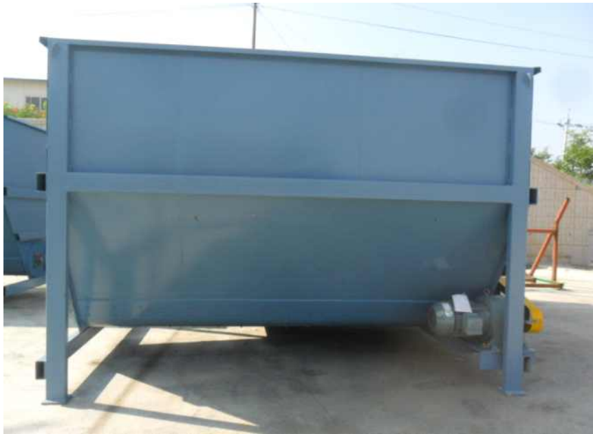
<제작된 부산물사료 임시대기 시스템>
