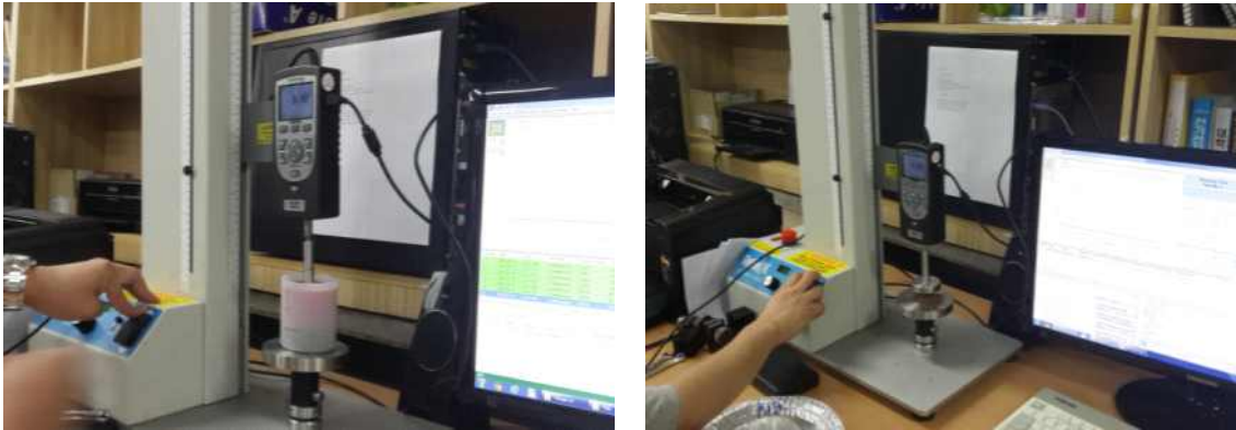
<부착력과 응집력 측정장치 및 방법>
