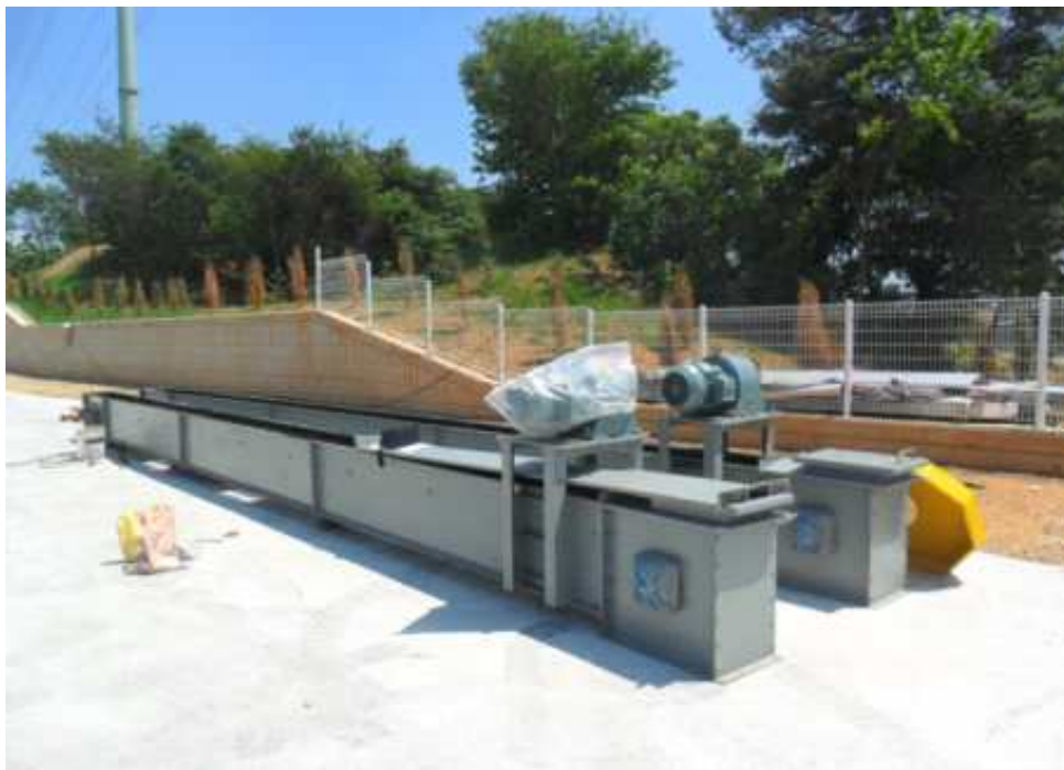
<제작된 부산물사료 프리믹스사료 배출이송 시스템>
