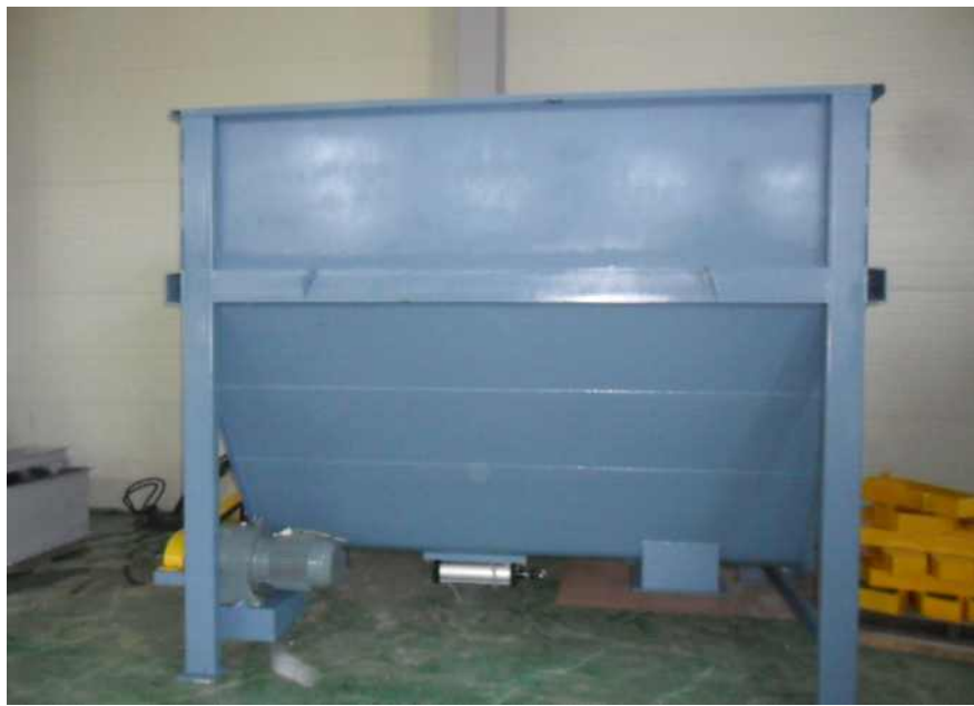
<제작된 건식 부산물사료 임시대기 및 저장 장치>
