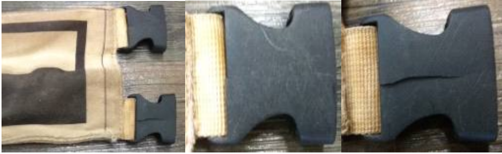
[ 클립 고정장치가 파손된 패턴목걸이 ]
