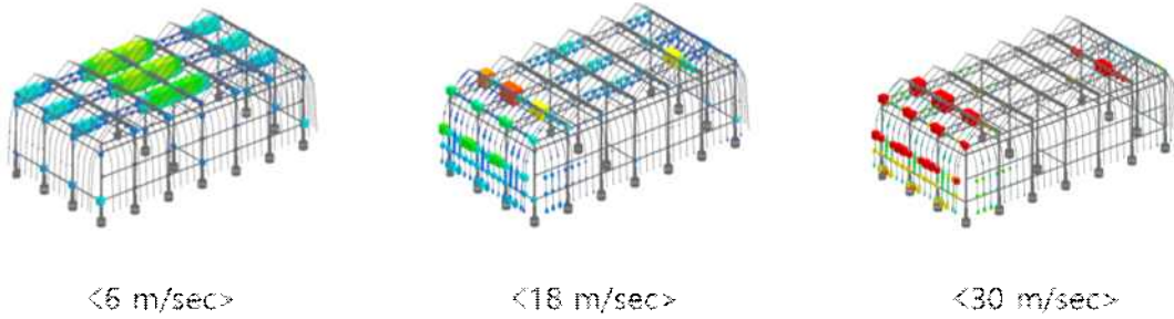
[그림 77] 중력과 wind load가 고려된 온실의 응력해석 결과
