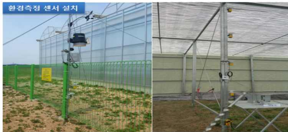
[그림 210] 데모온실에 설치된 환경센서
