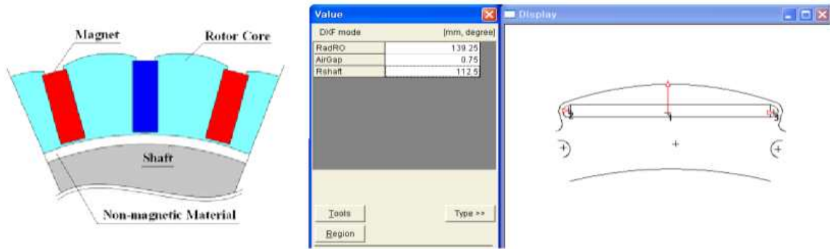
(a) IPM구조의 일반적 형상 (b) 세부적인 IPM 구조의 형상 및 설계값 IPM 구조를 이용한 설계.
