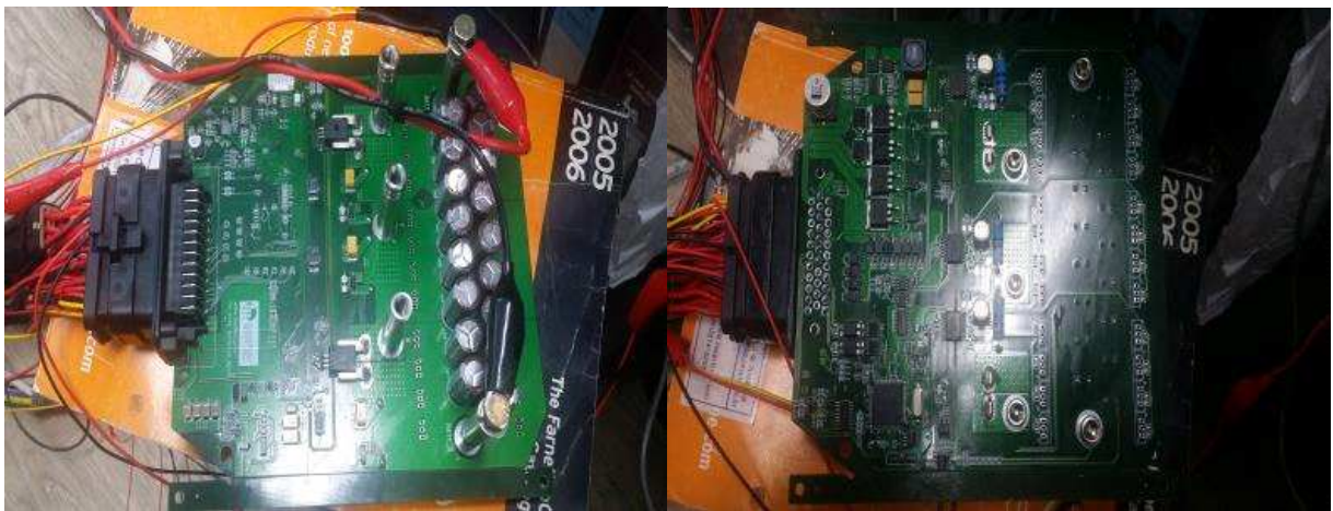
PCB Reversion B 12V/5A DC/DC Converter 조립 및 디버깅.
