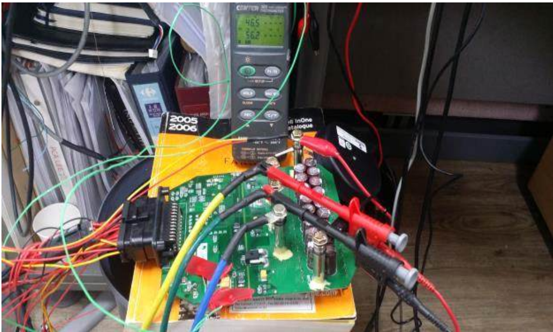
PCB Reversion B 12V/5A DC/DC Converter 온도 측정.
