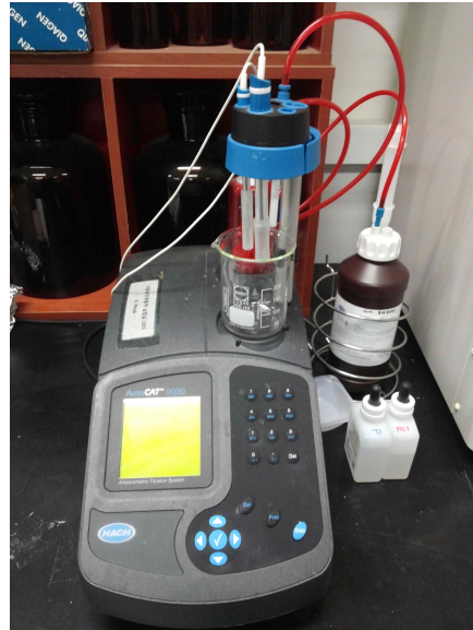
Fig 52. 이산화염소 잔류량 측정장치(AutoCAT)
