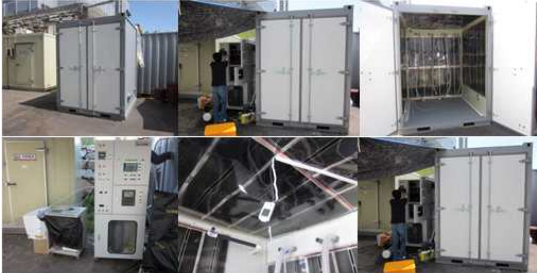
그림 28. 이산화염소 가스 살충력 실험을 위한 컨테이너
