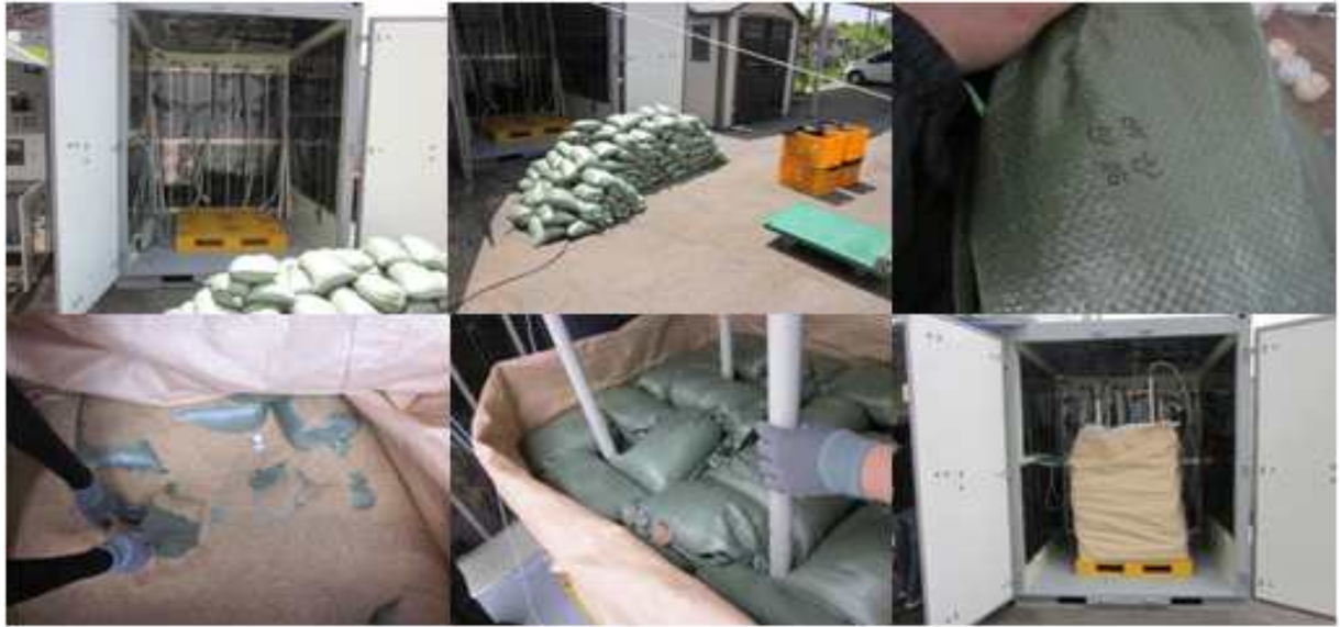
그림 30. 컨테이너 내부 톤백에 곡물주머니 설치 과정
