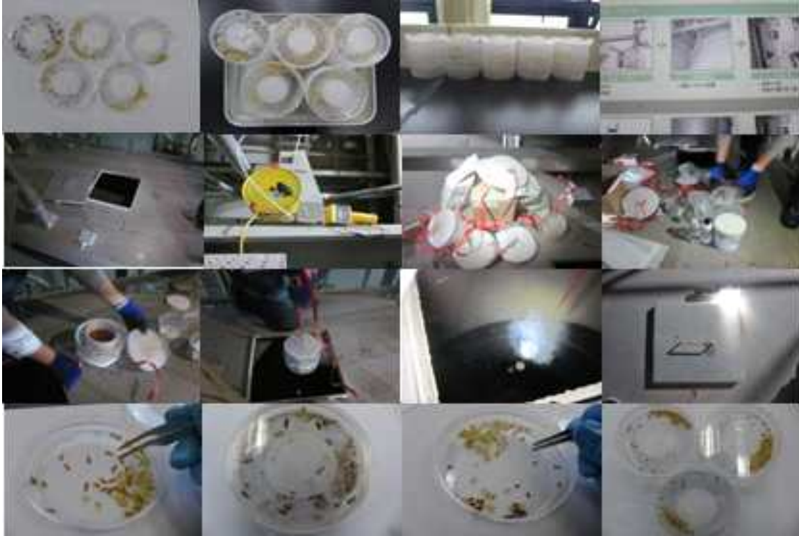
그림 47. 의성 RPC에서의 이산화염소 현장 처리 및 생존률 조사 과정
