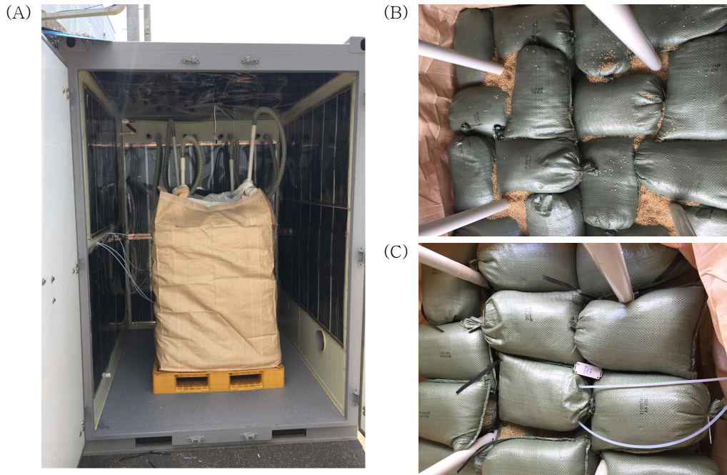
Fig 32. 소포장된 현미를 12층으로 쌓아올린 모습 (A), 공극에 현미를 부어서 공극을 제거 (B), 내부 이산화염소 가스 농도, 온도 및 습도 측정을 위한 센서 설치 (C)
