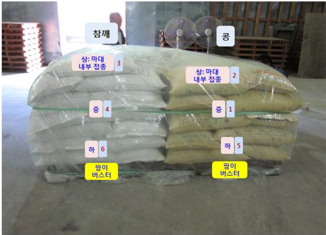
그림 25. 대구 이현 비축기지에서의 팜이버스터 살충력 검증을 위한 공시층 처리 상황
