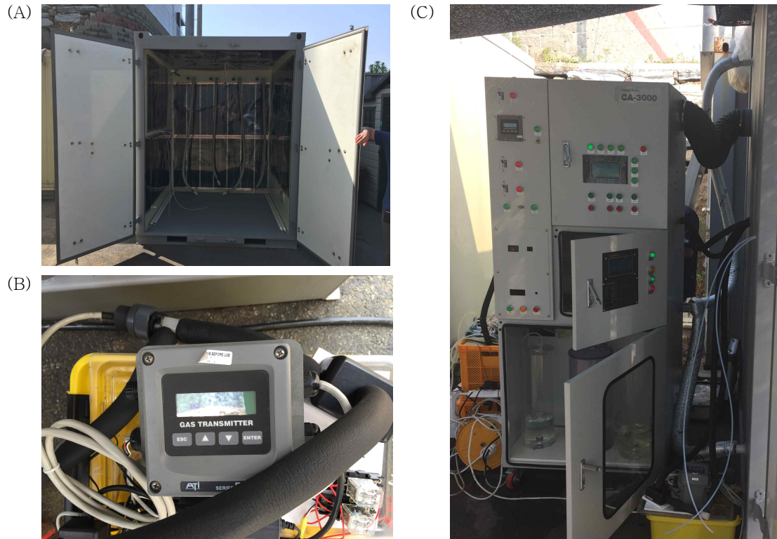
Fig 31. 제작한 이산화염소 가스 처리용 컨테이너 (A), 이산화염소 가스 공급기 (B), 컨테이너 내부 이산화염소 가스 농도 측정기 (C)
