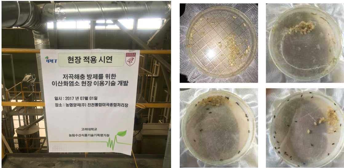
Fig 51. 진천 RPC현장(왼쪽) 실제 사일로 이산화염소 처리 후 치사 상태(오른쪽)
