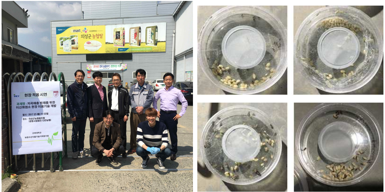
Fig 50. 의성 RPC현장(왼쪽) 실제 사일로 이산화염소 처리 후 치사 상태(오른쪽)
