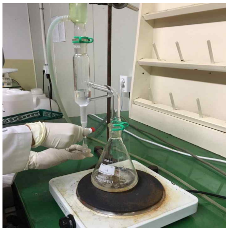
[그림 4-4] 증류장치(distillation apparatus)를 이용한 공비 증류모습과 채취한 증류액
