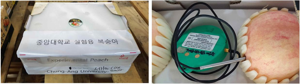
그림 3-10. 중앙대학교 실험용 복숭아와 품온 측정기를 장치한 모습
