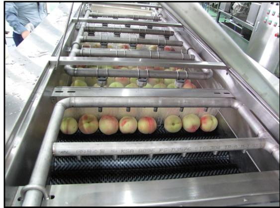
그림 2-11. 브러쉬 세척기를 이용한 복숭아 세척
