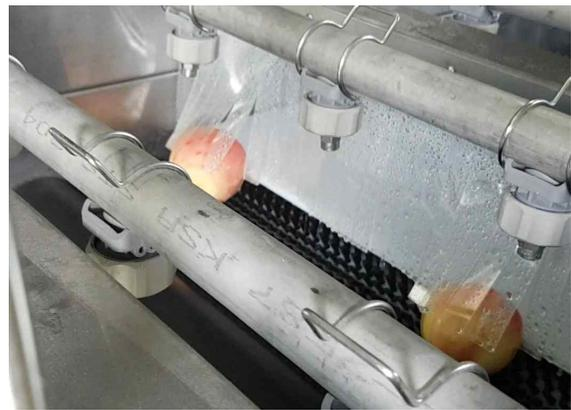
그림 3-7. 브러쉬 세척기를 이용한 복숭아 세척
