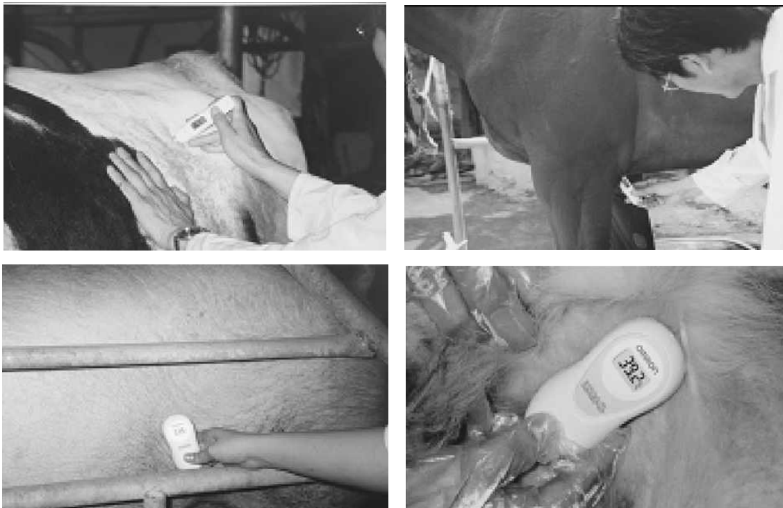
그림 2. 비접촉성 체온계 테스트 실험방법
