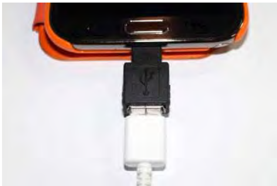
그림 140. USB IR 체온계 연결 (스마트폰) 그림 141. USB IR 체온계 연결 (체온계)
