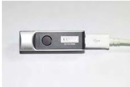
그림 140. USB IR 체온계 연결 (스마트폰) 그림 141. USB IR 체온계 연결 (체온계)
