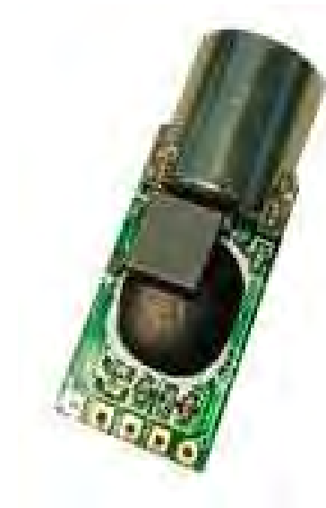
그림 115. 비접촉 IR 온도센서
