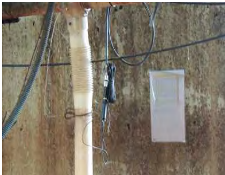
그림 64. 음성분석용 마이크 설치 모습 작은 크기에 비해서 집음력이 상당히 좋으며 녹화와 동시에 녹음 가능
