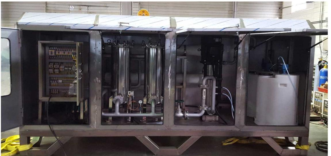
기수담수화 시스템 제어반 작동 TEST
