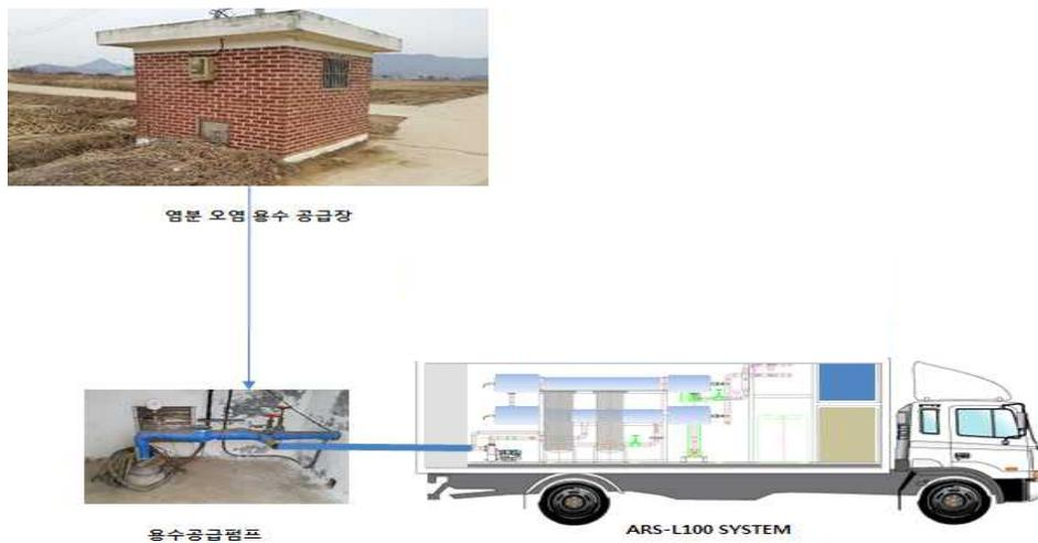
그림 8.3 이동식 담수화 시스템 관정 배관 방식
