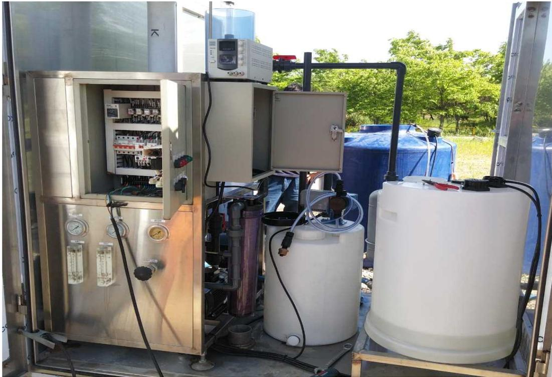
그림 5.32 기수담수 PILOT PLANT 시스템 현장 설치
