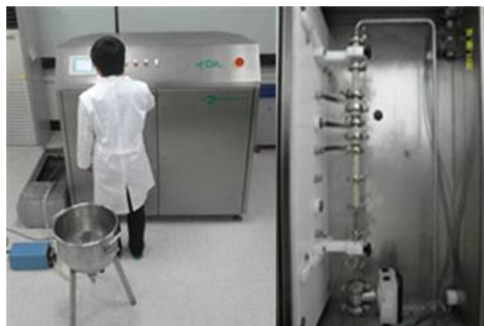
Fig 109. PEF production line(사진 좌) ; continuous chamber(사진 우)
