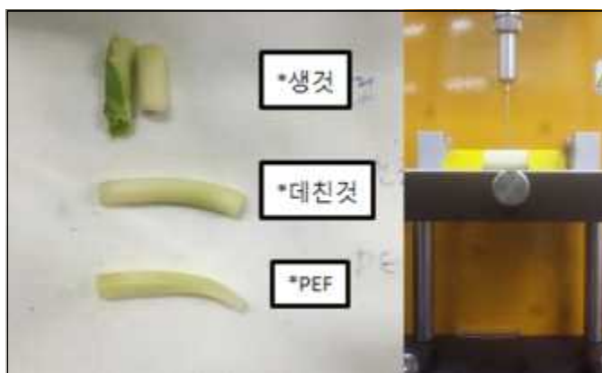
Fig 54. T.A 측정을 위한 전처리(지름 1 cm Cork Borer 관통) 및 T.A 측정(needle : 1.0 mm D, 43 mm L)
