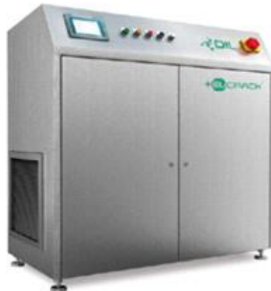
Fig 107. 실험에 사용된 5 kW급 펄스전기장 발생장치 (HPV5, DIL, Germany)
