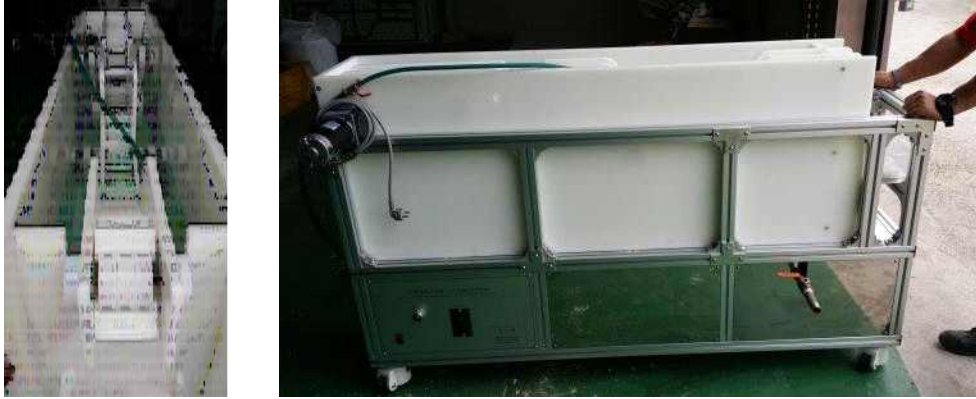
Fig 167. 제작 완료된 연속형 펄스처리조의 시료투입구구 및 이송부분 (좌); 측면부분 (우)
