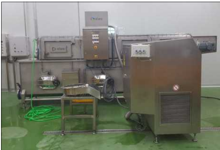
Fig 60. 생산용 30 kw 고체 연속처리 PEF 기기구성
