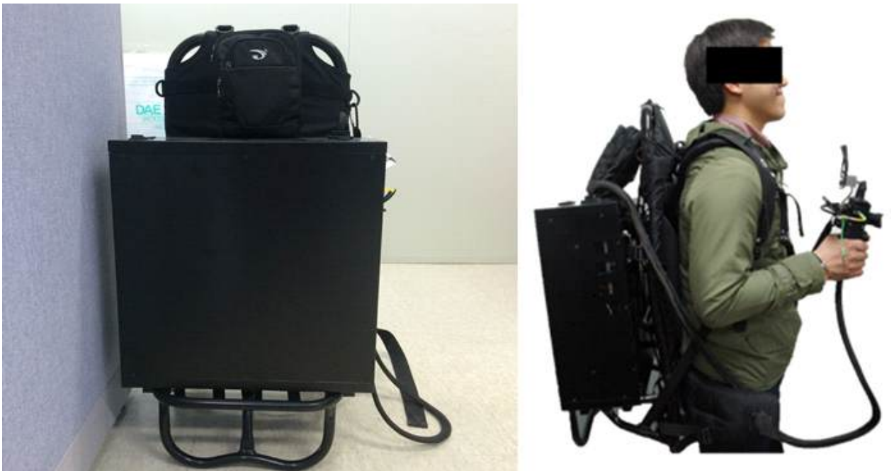
그림 245. 백팩형 OCT 착용한 모습, 등에 백팩형 OCT를 장착하고 오른손에 프로브를 이용하여 타겟을 촬영함
