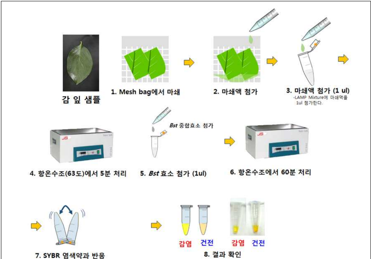
그림 71. 감 둥근무늬낙엽병 진단용 LAMP법의 모식도
