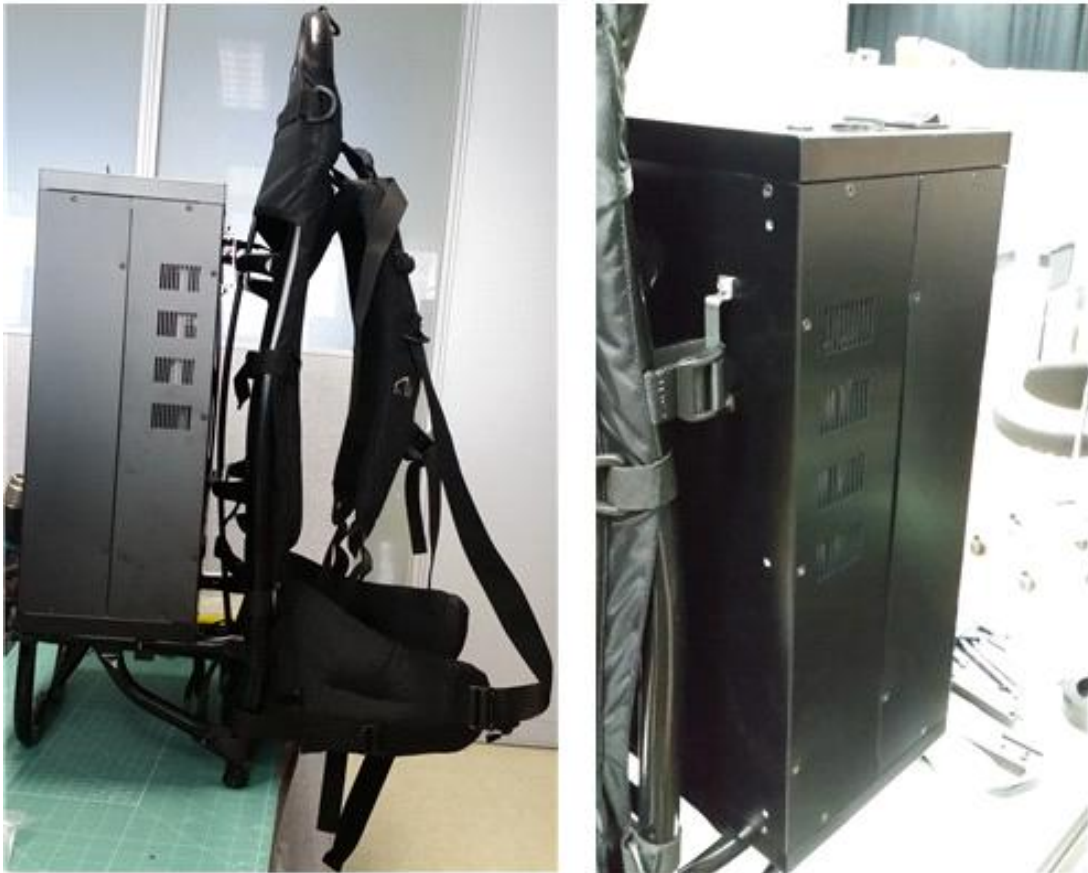
그림 242. OCT 본체 시스템을 휴대하면서 샘플을 측정할 수 있도록 백팩 형태로 제작, OCT 시스템이 떨어지지 않도록 안전장치 제작
