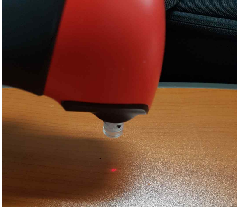
그림 335. 눈에 보이는 적색 불빛을 가이드 빔으로 사용
