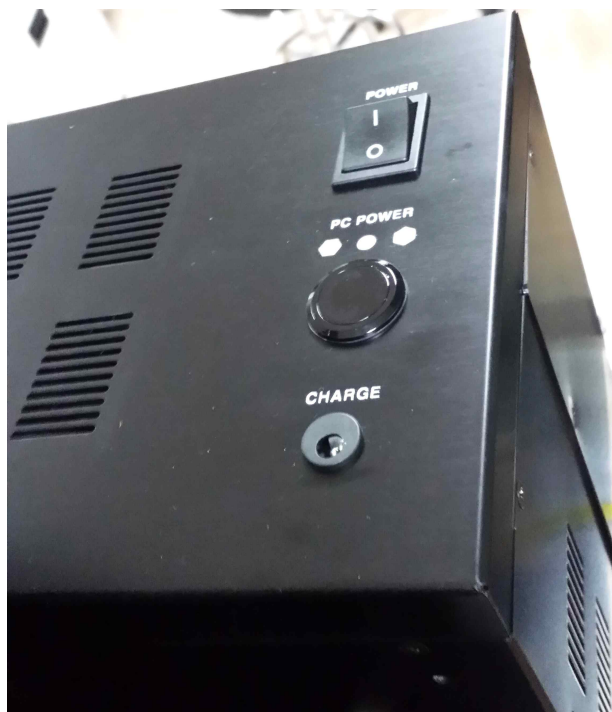
그림 240. OCT 본체 전원 스위치와 미니 PC 전원 버튼 및 배터리 충전 단자
