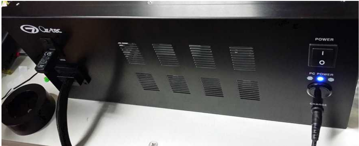
그림 246. 충전중인 OCT 시스템, 우측 Charge 위치에 충전기가 꼽혀있을 경우 위쪽에 Power에 파란 불이 들어오는 것을 볼 수 있음.
