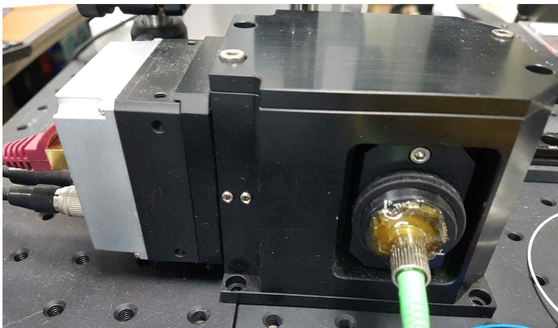
그림 289. 제작한 콤팩트 스펙트로미터
