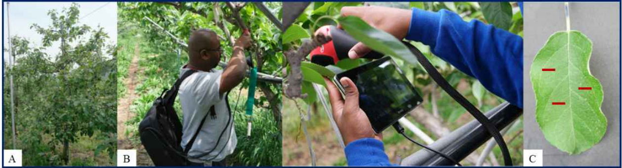
그림 54. 휴대용 SD-OCT를 이용한 사과 갈색무늬병 진단 실험. A: 조사대상 나무, B: 휴대용 SD-OCT를 이용한 대상잎의 촬영 모습, C: 촬영 부위. Red line: 촬영 부위
