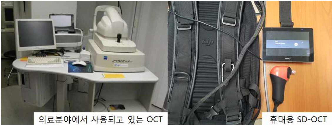
그림 357. 기존에 의료분야에서 사용 중인 OCT 및 본 연구에서 개발된 휴대용 OCT
