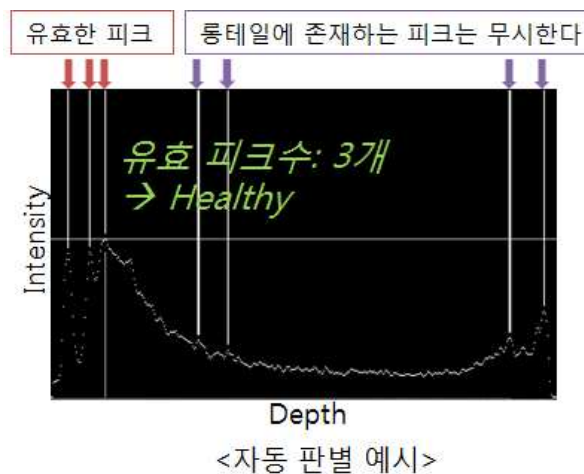
그림 222. 유효 피크수 자동 판별 예시
