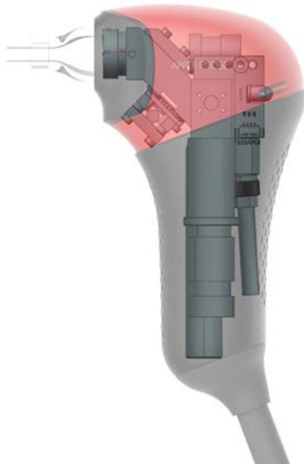
그림 279. 내부 구조물이 들어가 있는 프로브의 모습
