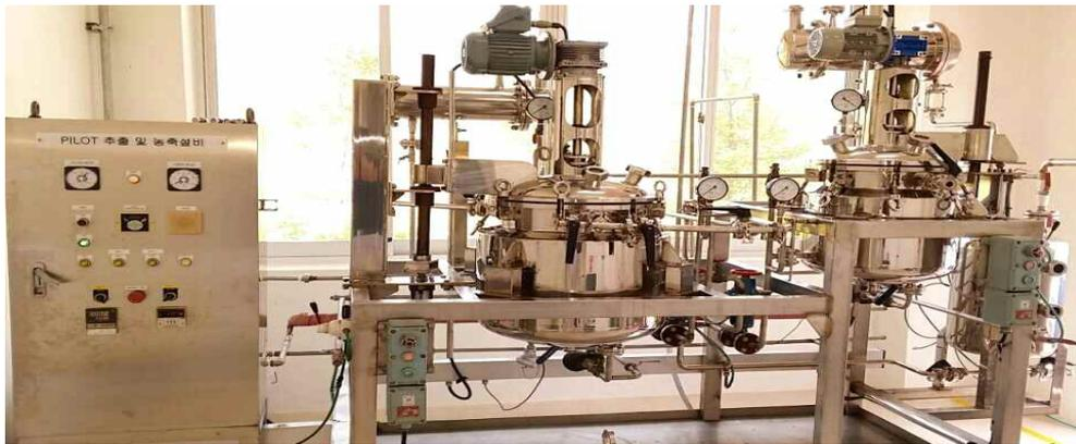
Fig. 17. 복분자씨부산물 제조용 추출농축기 전경(pilot설비)
