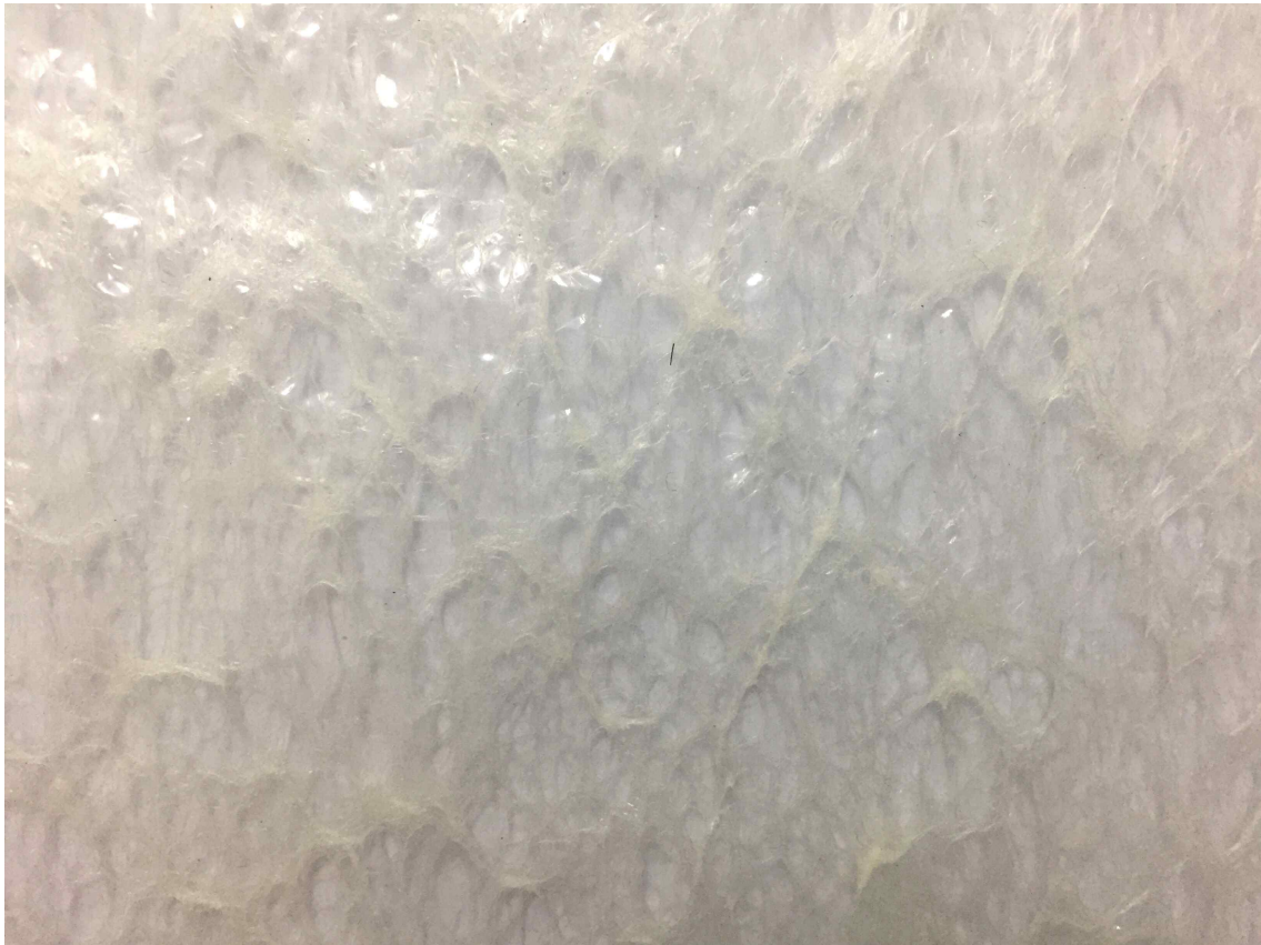
그림. 20 wt% 베이킹 소다/LDPE 마스터배치 단독 필름, 압출 및 blowing 시 높은 온도로 인하여 발포가 일어난 필름 형상
