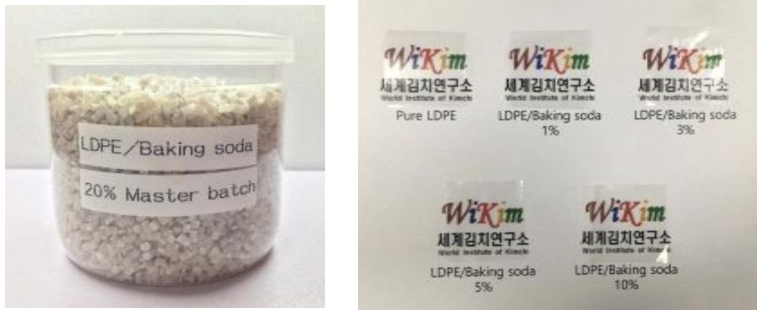
그림 6. 개발한 탈취기능성 마스터배치 및 필름
