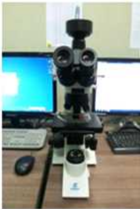
그림 24. 비천공 가공 계측검사 광학현미경 측정 내용
