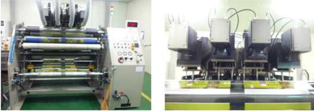
그림 8. 나노초 레이저(355nm 파장, 20kHz 반복률, 25ns 펄스폭) 장비, 30 \mu m 두께의 필름에 깊이 10-20 \mu m, 직경 5-20 \mu m 크기의 원형 홈을 가공하는 기술
