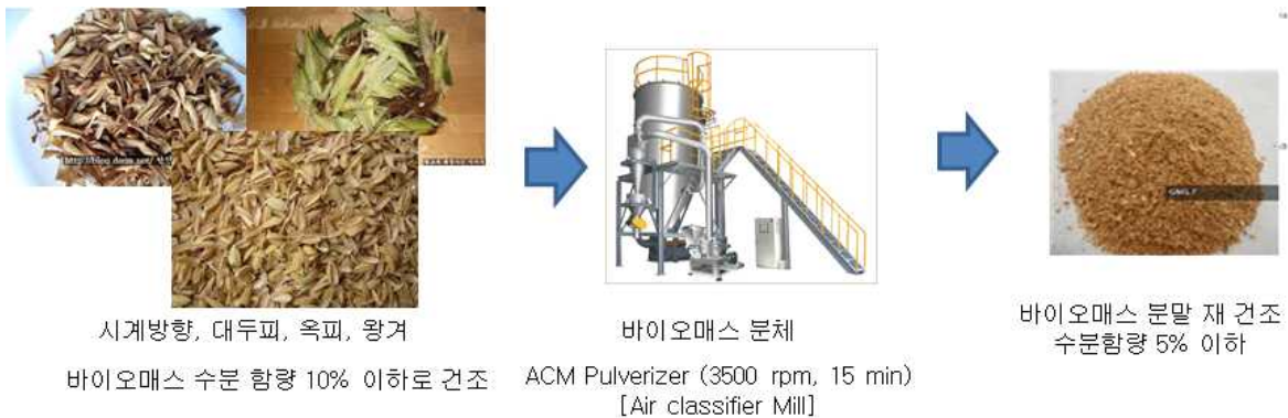
그림 30. 바이오매스의 분체를 통한 입자 제조 과정
