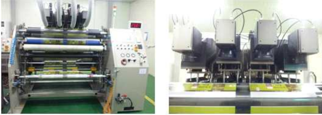
그림 136. 나노초 레이저(355nm 파장, 20kHz 반복률, 25ns 펄스폭) 장비, 123 \mu\text{m} 두께의 필름에 깊이 -50-65 \mu\text{m} , 직경 40-50 \mu\text{m} 크기의 원형홈을 가공하는 기술
