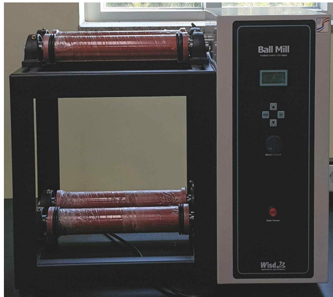
그림 51. 바이오매스의 분체에 사용된 ball mill
