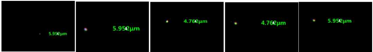
그림. Sodium, 비석유계, 열처리1, 열처리3, 일반LLDPE 원단 표면 광학현미경촬영
