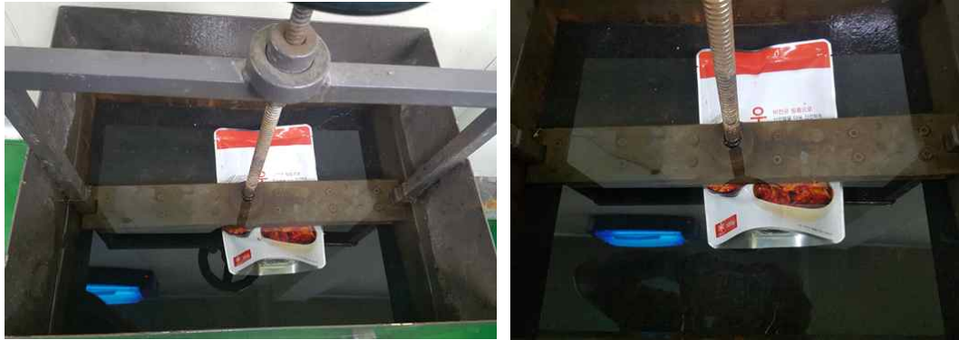
그림. 레이저 가공 김치파우치 압력test 진행
