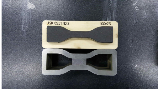
그림 190. JIS K 6251 기준의 sheet 커팅 칼날
