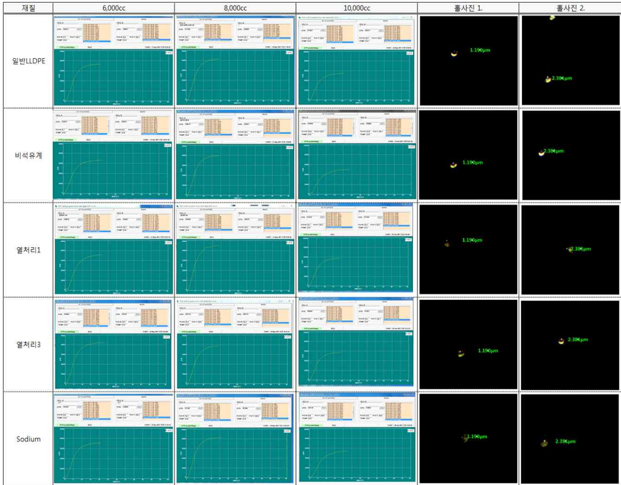
그림. 비석유계 천연물질과 일반LLDPE 합지원단 투과도 및 홀 크기 세부 자료
