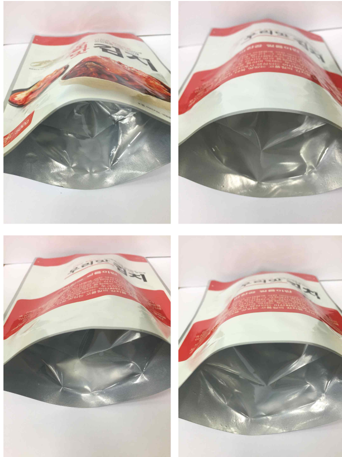
그림. 왼쪽 상단부터 시계 방향으로, 중층이 LDPE, RH/LDPE, 열처리 베이킹소다/LDPE, 베이킹소다 LDPE 필름 사용
