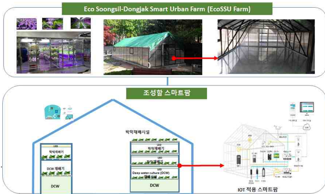
그림 3.1.29 재배시설 설치 개념도.
