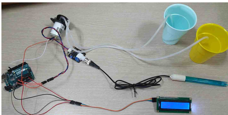
그림 3.3.22 아두이노 및 펌프, pH센서, LCD1602A 결합 구성도
