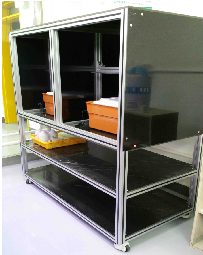
그림 3.5.6. 광량 최적화 실험을 위한 작물재배 시험 장치.
