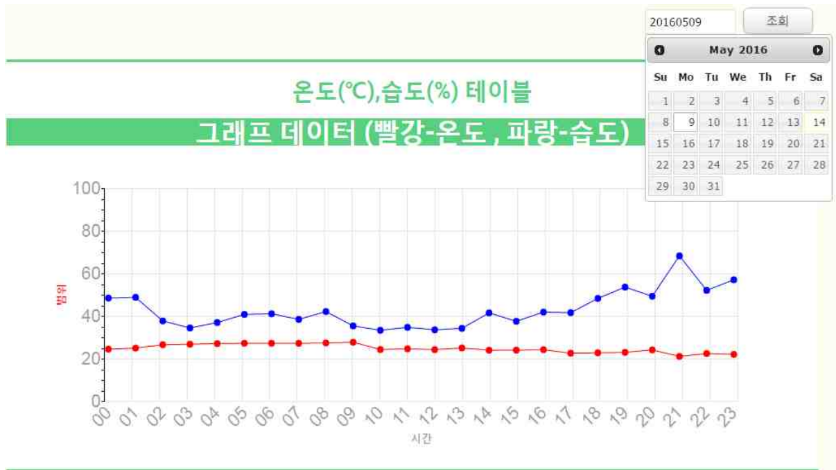
그림 3.3.17 그래프형 온습도 모니터링 시스템
