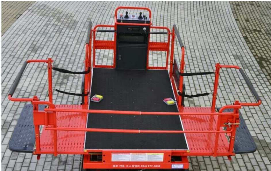
그림 54 4분할 확장작업대를 적용시킨 고소작업기계
