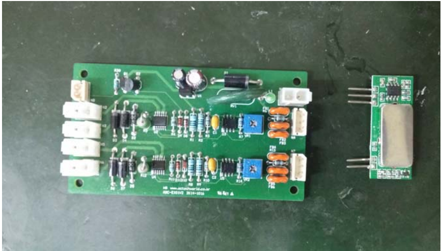
그림 48 경사조절용 연동 PCB 및 경사각 센서
