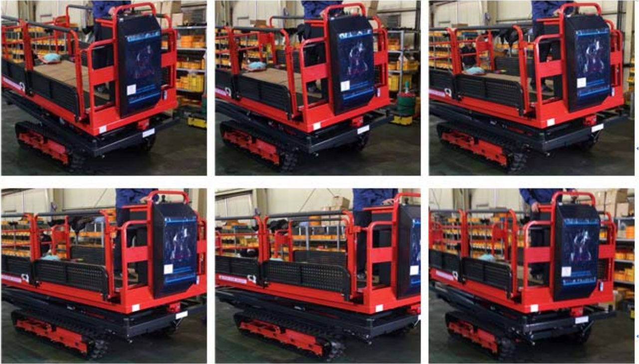
그림 51 Auto levelling system의 구현
