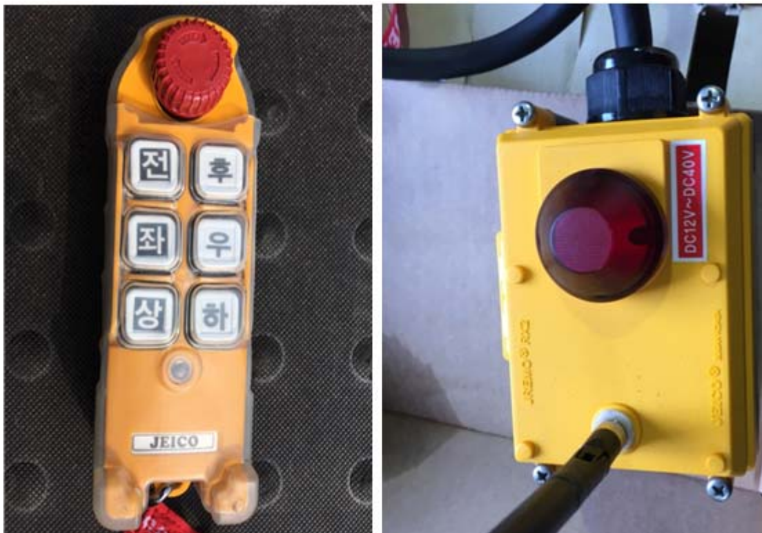
그림 76 주행 및 승하강 기능을 추가한 최종 원격컨트롤러
