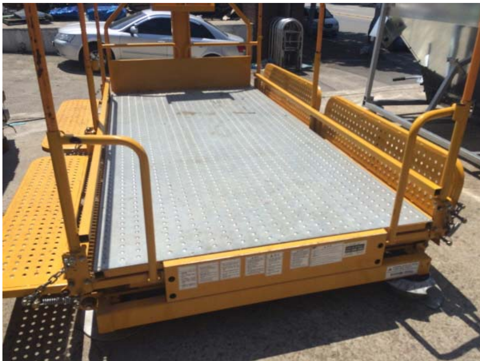
그림 53 슬라이딩 및 인장스프링에 의해 확장이 가능한 작업대
