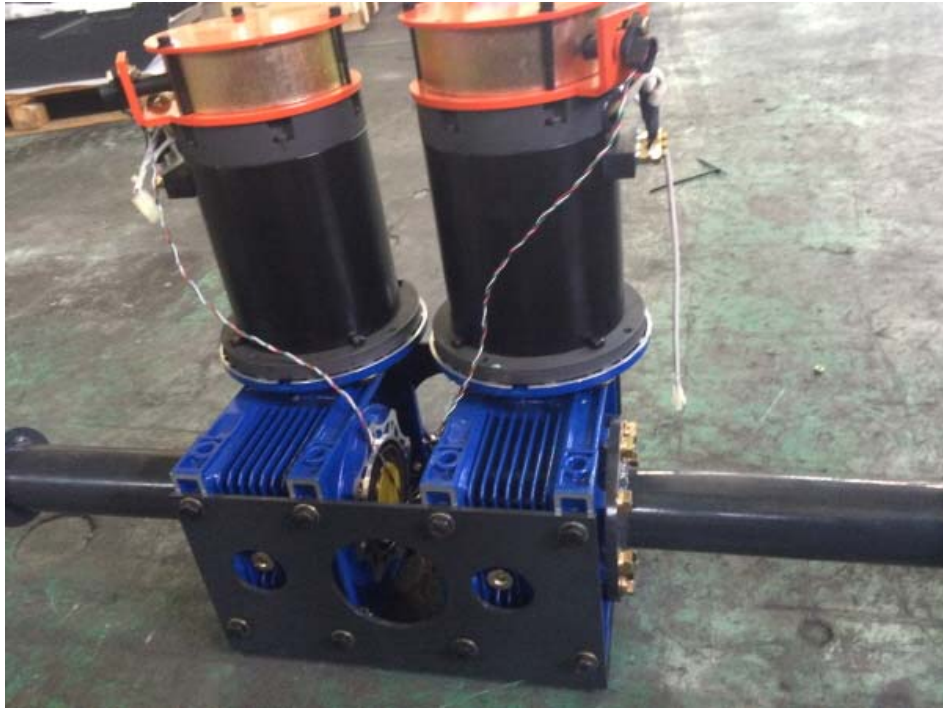
그림 41 적용된 AC모터 및 감속기부
